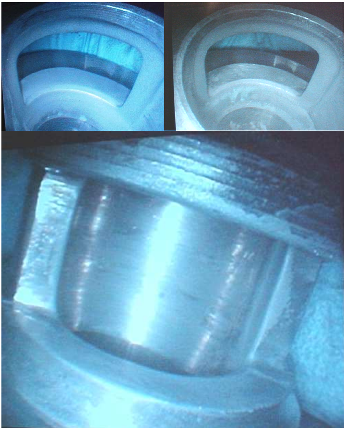
Figura 39 – Peças após processo ECM Fonte: A autoria própria
