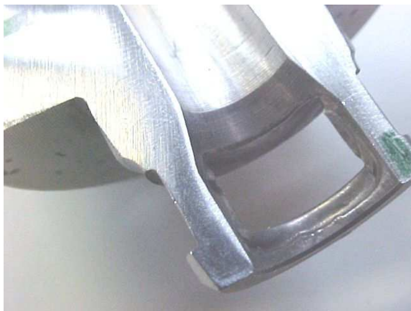
Figura 33 - Peça em Corte da Peça Usinada por Rebarbação Eletroquímica Fonte: Autoria própria
