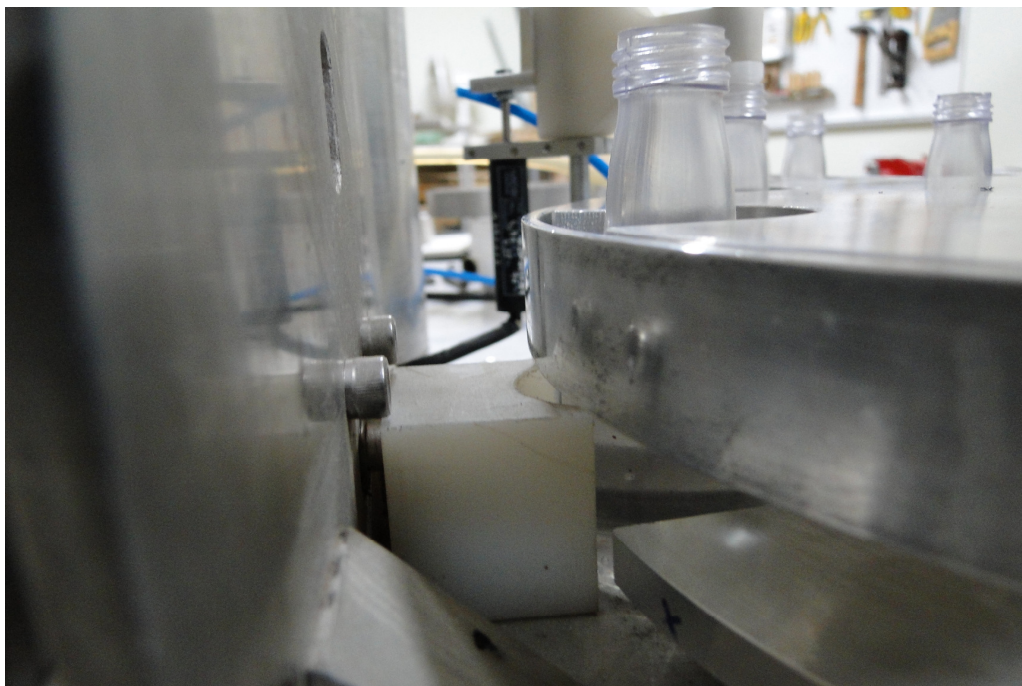
Figura 44 – Fixador de garrafa da estação de rosqueamento Fonte: Autoria própria
