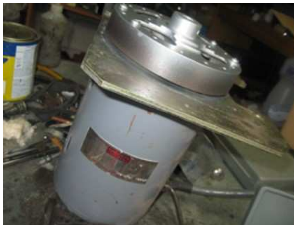
Figura 47 – Motor trifásico 0,75 kW Fonte: Autoria própria.
