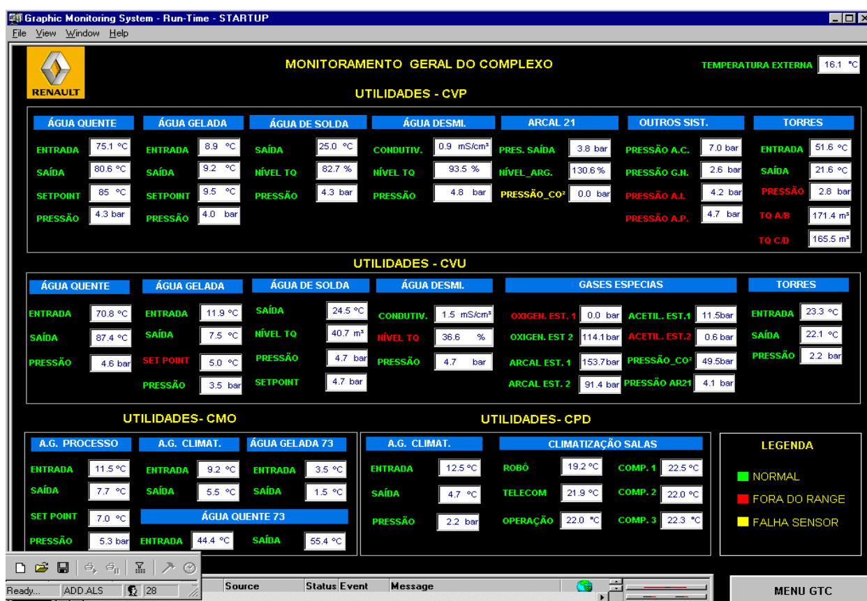
Figura 7 – Sistema Supervisório Cube para o monitoramento geral da Renault do Brasil Fonte: Renault do Brasil (2010)
