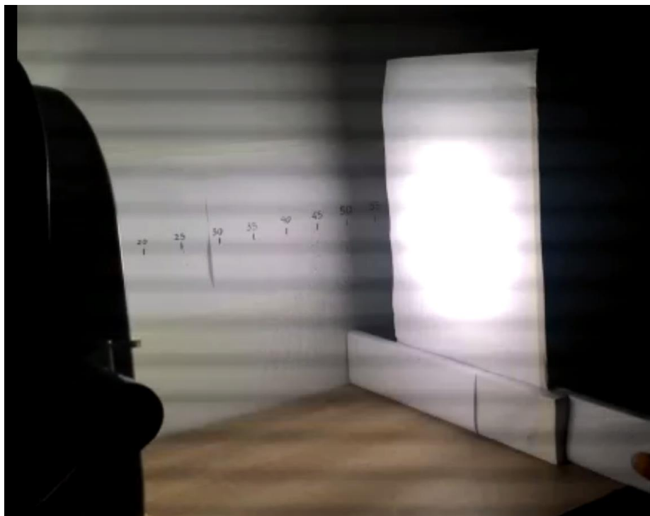
Figura 61 - Campo luminoso com sistema de ajuste automático a 500 mm
