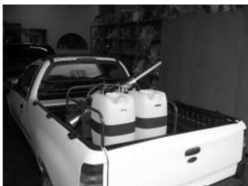
Dependendo do modo de utilização, o equipamento deverá ser adequadamente posicionado sobre o veículo. Assim, quando for trabalhar com formulação à base de água (modo UBV), recomenda-se utilizar o canhão inclinado e voltado para a lateral do veículo, em direção à área de tratamento.
