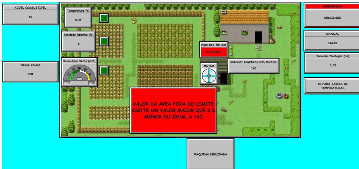
Nela contém informações a respeito da temperatura ambiente, umidade relativa do ar, velocidade do vento, estados em tempo real do termonebulizador, níveis de combustível e de calda nos tanques, área da plantação e também informações sobre os sensores utilizados em campo.
