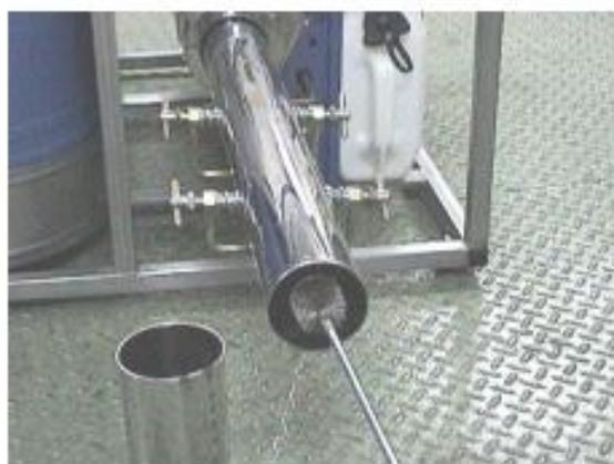
Os tubos de admissão do ressonador (onde fica a vela) e a vela devem ser limpos a cada 40 horas de uso. Para isso retire a vela, solte as 6 porcas que fixam o ressonador ao chassis, afaste-o alguns centímetros e limpe os tubos de admissão internamente com uma escova de aço, raspador ou eventualmente uma chave de fenda, removendo os resíduos. Limpe a vela com uma escova de aço e monte novamente o conjunto.
