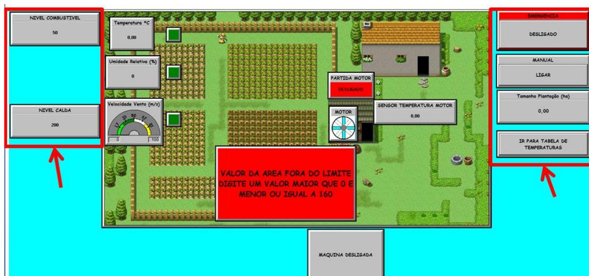
**Displays de nível de Combustível e de Calda:** localizados na parte esquerda do sistema supervisor, indicam os níveis de combustível e de calda atualmente nos tanques do termonebulizador. O software foi programado para quando os níveis de combustível e de calda fiquem abaixo de 10L nos galões o botão de Emergência se ativará automaticamente. Quando isso ocorrer irão aparecer alarmes em tela indicando o ocorrido.
