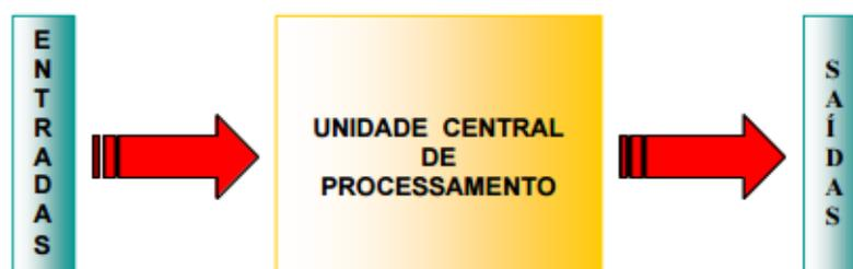
**Figura 6 - Estrutura básica de um CLP**
