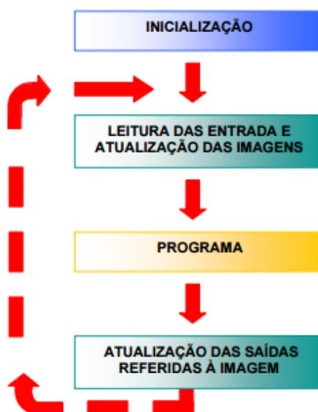
Figura 7 - Ciclo de processamento dos CLPs
