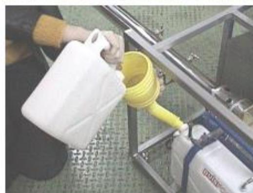
**Atenção: Jamais adicione óleo 2 tempos ou qualquer outro tipo de aditivo à gasolina!! Procure evitar o uso de gasolina suja, que contenha impurezas sólidas. Se possível, abasteça diretamente na bomba do posto de gasolina.**
