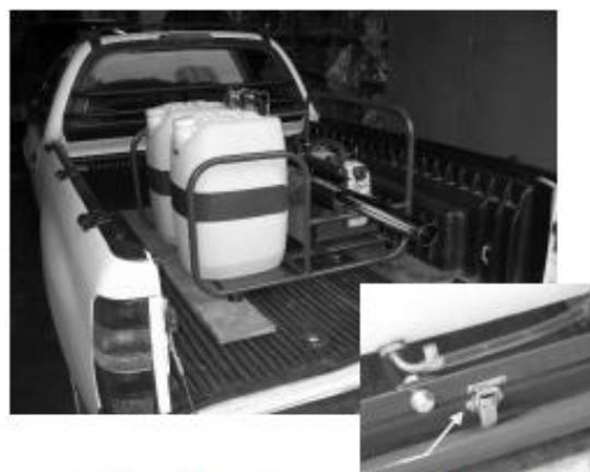
Para otimizar a distribuição do produto, quando estiver trabalhando com formulações à base de óleo mineral (modo FOG), recomenda-se utilizar o canhão abaixado e voltado para a traseira do veículo.
