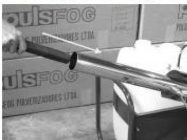
1 – Introduza a ferramenta de troca de tubos pela boca do canhão e fixe-a ao tubo nebulizador.
