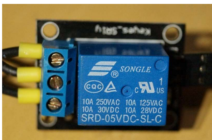
Figura 6 - Relé de saída SRD-05VCD-SL-C Fonte: Autoria própria
