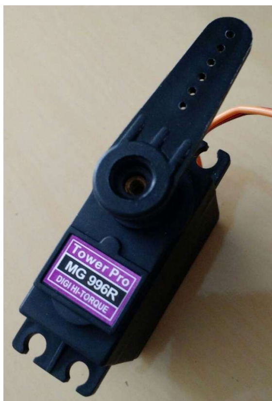
Figura 8 - Servo motor MG 996R Fonte: Autoria própria
