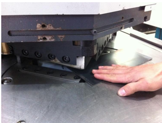
Figura 5 - Corta Canto risco de mutilação das mãos Fonte: Autoria própria
