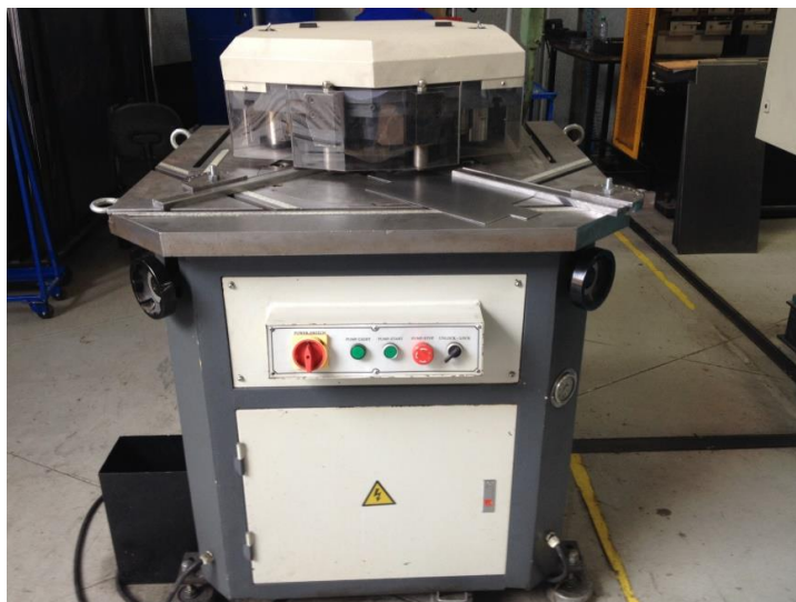
Figura 7- Imagem Corta Canto com Proteção de Acrílico Fonte: Autoria própria.
