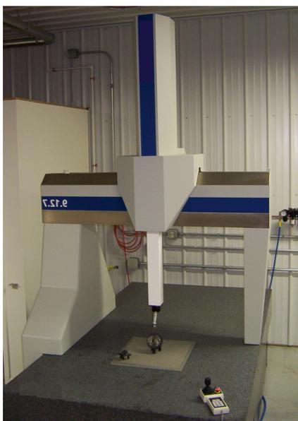
**Figura 3: Máquina de medição por coordenadas com braço perpendicular rígido que utiliza o princípio do contato físico para extrair a nuvem de pontos de um modelo.**
