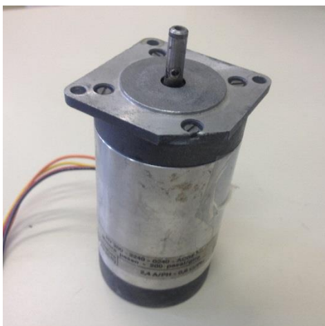
Figura 26 – Motor substituto eixo Z Fonte: Autoria própria.
