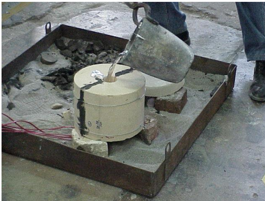
Figura 3 – Vazamento de liga metálica em molde cerâmico Fonte: Alves, 2000.
