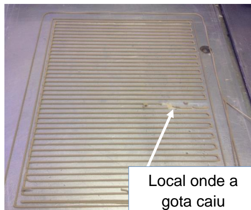
Figura 65 – Falhas causadas pela exsudação Fonte: Autoria própria.
