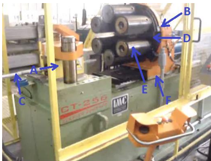
Figura 18 - Exemplo de conformadora de tubos e seus componentes de fixação (A) e movimentação (B)
