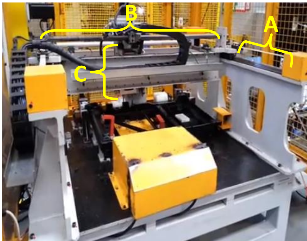
Figura 38 - Dispositivo de fresagem CNC e seus eixos. Eixo transversal (A), longitudinal (B), profundidade (C).
