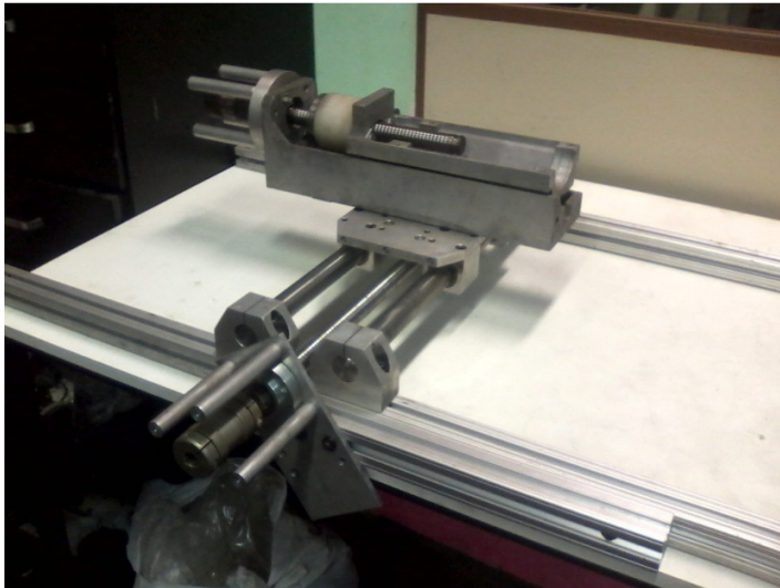
Figura 5 – Eixos lineares da bancada experimental
