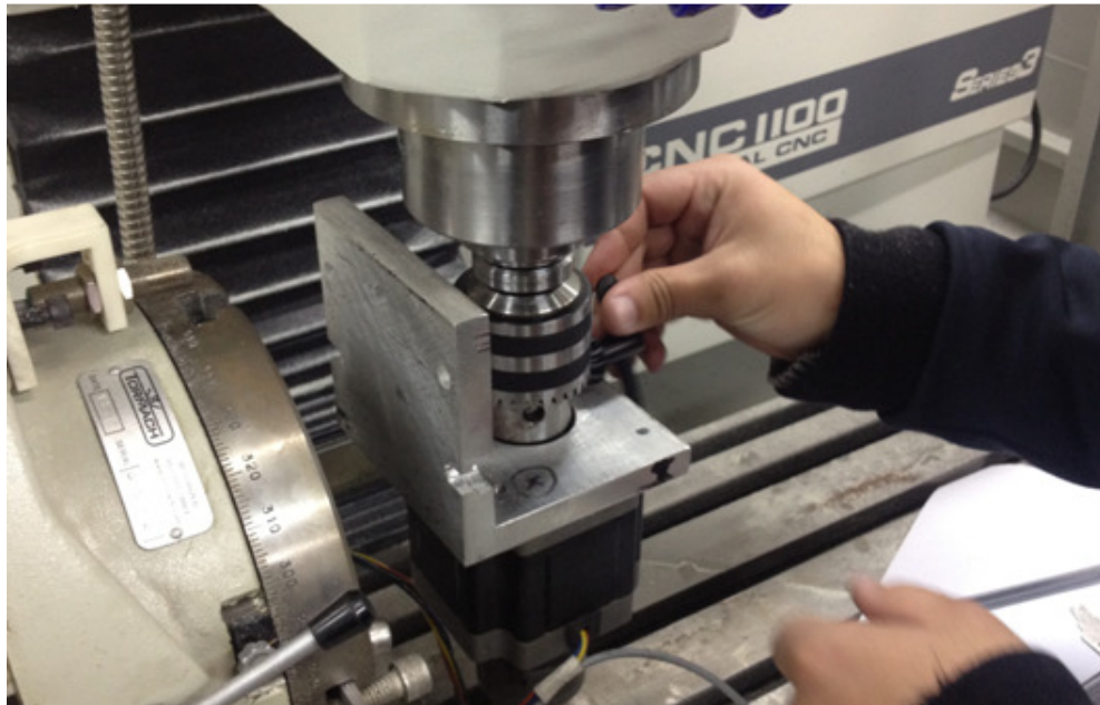
Figura 22 – Referenciamento da fresadora Tormach com auxílio de mandril
