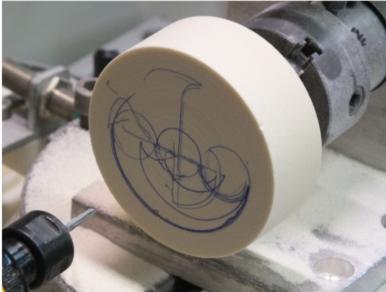
Figura 13 – Código G inicial executado com caneta no lugar da ferramenta
