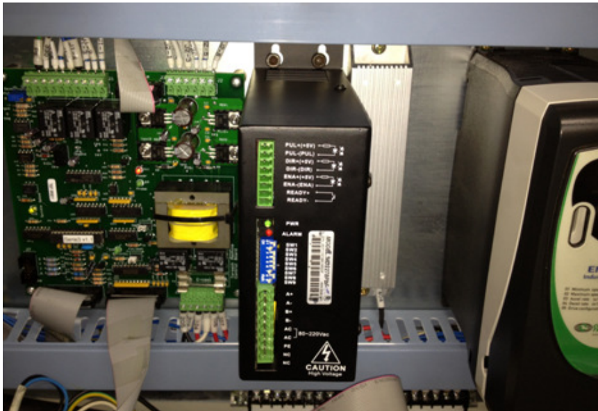
Figura 19 – Driver do quinto eixo adaptado no painel da fresadora
