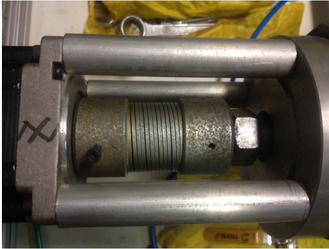
Figura 8 – Motor de passo acoplado ao eixo Z da bancada experimental
