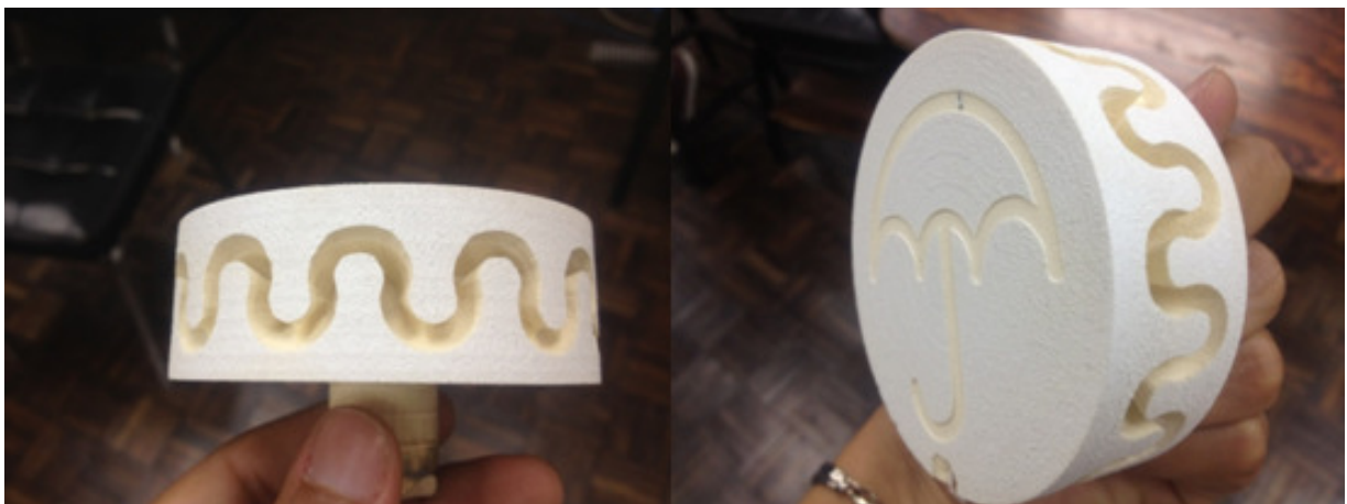
Figura 15 – Usinagem do contorno lateral, na bancada experimental
