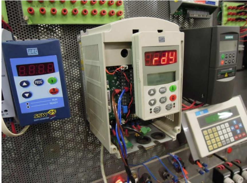
**Figura 45 – Conexão dos fios de comunicação no inversor**
