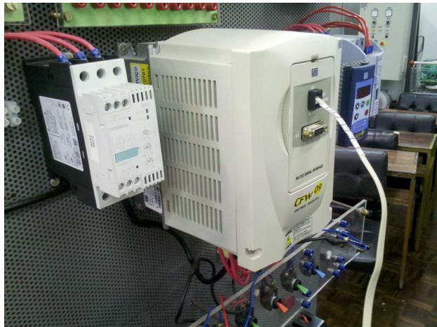
**Figura 8 – Inversor CFW-09 WEG do laboratório da UTFPR**
