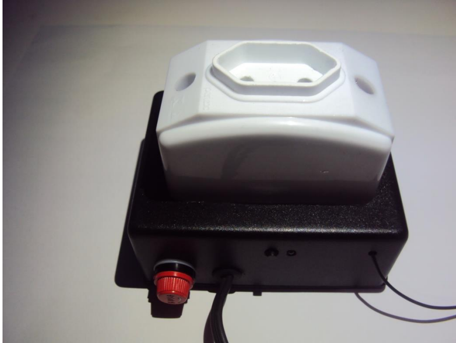
Figura 22 - Módulo Auxiliar com foco no botão de programação. Fonte: Autoria própria.
