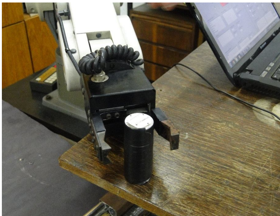
Figura 49: Robô pega a peça em uma posição pré-gravada qualquer
