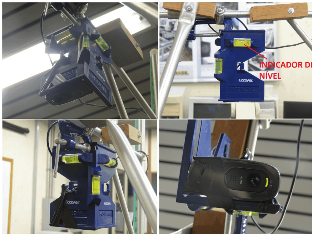
Figura 29: Medidor de nível acoplado à câmera
