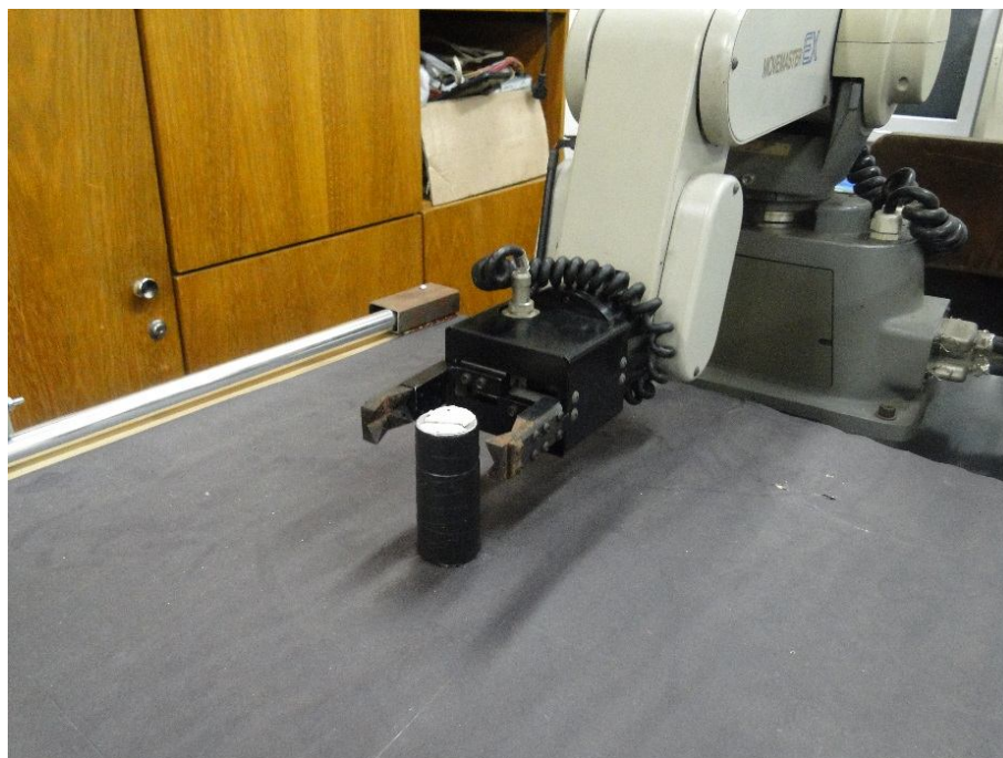
Figura 50: Robô leva a peça até o ponto P_1
