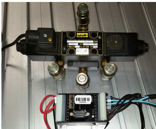
Figura 9 – Válvula proporcional com acionamento elétrico (Autoria própria) Conjunto utilizado no Laboratório de Hidráulica da UTFPR
