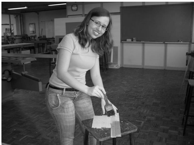
Figura 32: Peças de acabamento recebendo aplicação de cola de contato.
