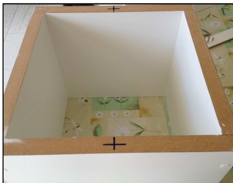
Figura 82: Marcação para pinos invisíveis do nicho. Fonte- Arquivo da autora, 2014.
