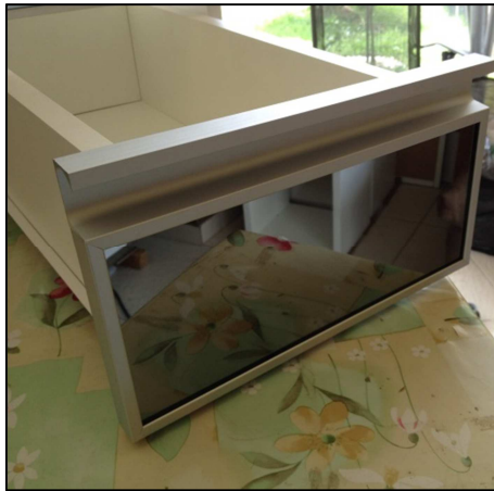
Figura 114: Colocação da frente do gaveteiro. Fonte: Arquivo da autora, 2014.
