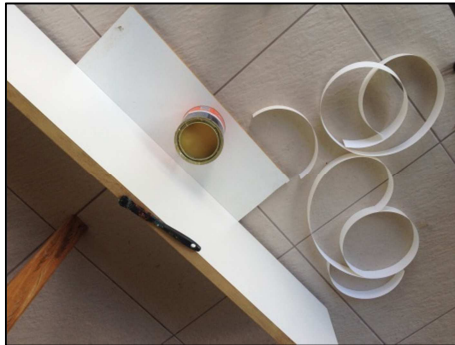
Figura 104: Passar cola nas chapas e fitas de borda. Fonte- Arquivo da autora, 2014.
