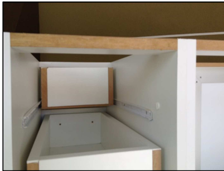
Figura 111: Montagem do módulo gaveteiro com as gavetas e corrediças. Fonte: Arquivo da autora, 2014.
