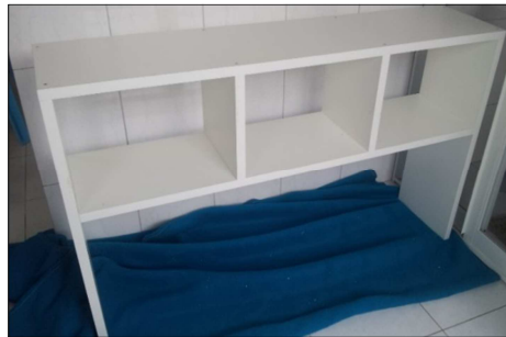
Figura 56: Montagem das laterais internas. Fonte- Arquivo da autora, 2014.
