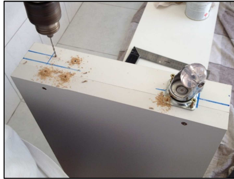
Figura 58: Instalação dos rodízios. Fonte- Arquivo da autora, 2014.
