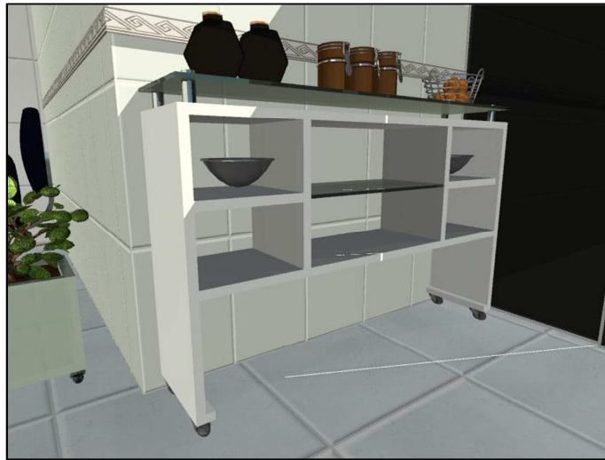
Figura 26: Aparador com rodízio e duas chapas verticais centrais, duas prateleiras em madeira, uma prateleira em vidro.
