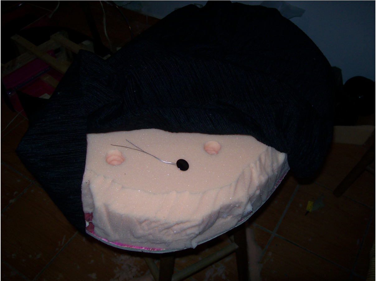
Figura 31 – Furação da espuma e botão de aço cromado.
