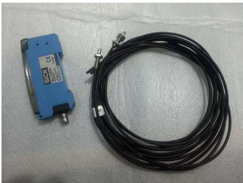
**Figura 5.3.3.2 - Sensor fotoelétrico de fibra-óptica amplificada.**
