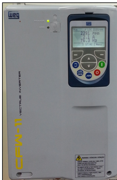
Figura 44 - Vista frontal do inversor de frequência Fonte: Os autores, 2014.
