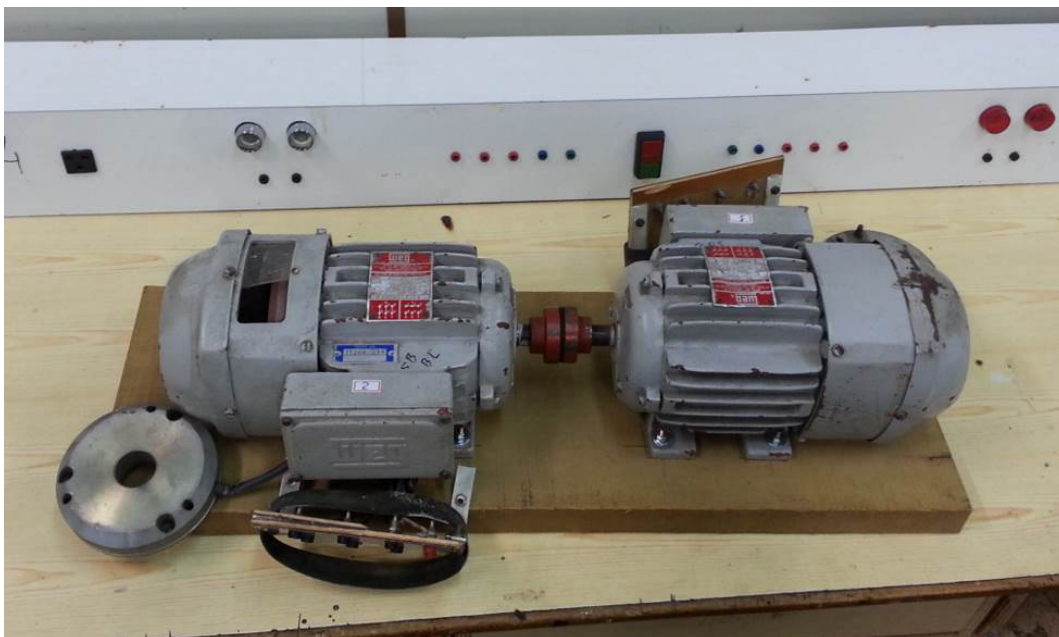
Figura 53 - Acoplamento mecânico entre as máquinas de indução Fonte: Os autores, 2014.
