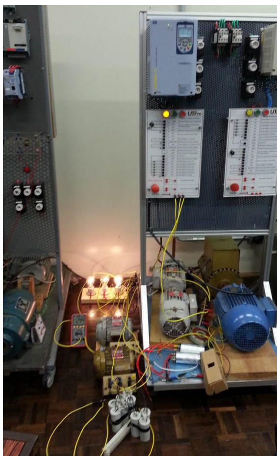
Figura 54 - Exemplo da montagem e ligação dos motores no inversor de frequência Fonte: Os autores, 2014.
