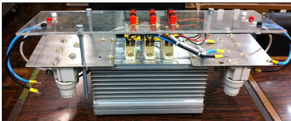
Figura 29 - Ponte de tiristores, dissipador de calor e fusíveis de proteção Fonte: Os autores, 2014.
