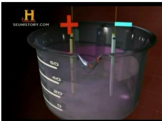
FIGURA 18 – Componentes básicos de uma bateria
