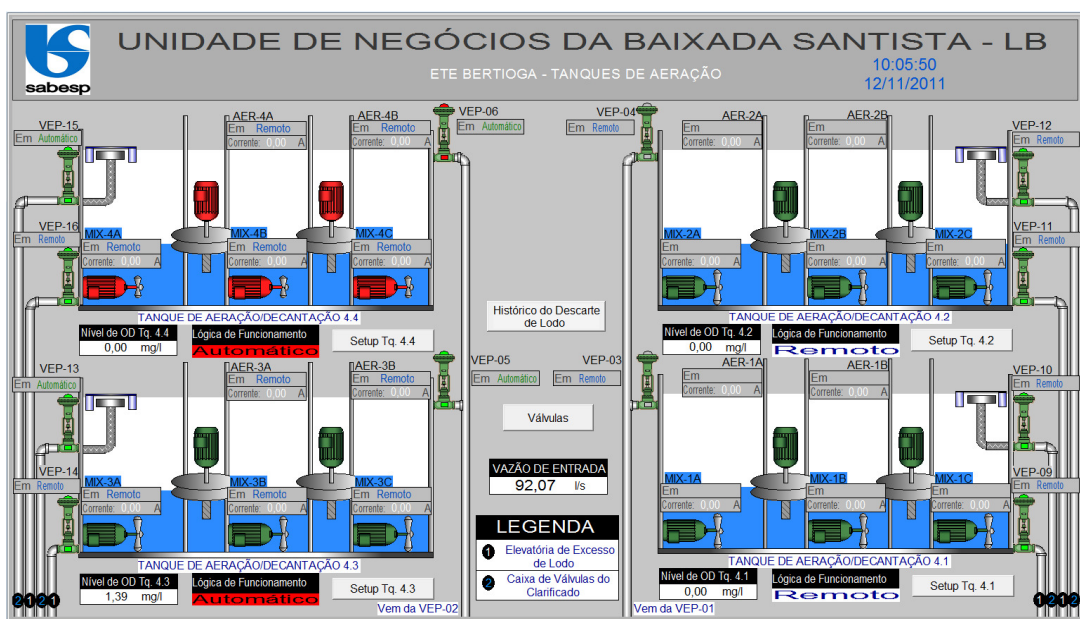
Imagem 6 - Tela geral dos tanques de aeração e decantação Fonte: Autoria própria.
