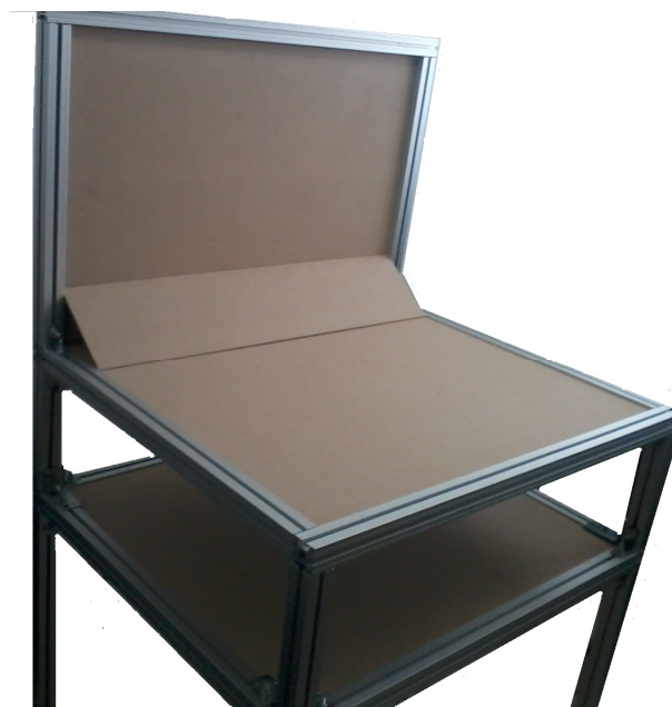
Figura 27: Montagem das chapas na estrutura Fonte: Autor do Estudo
