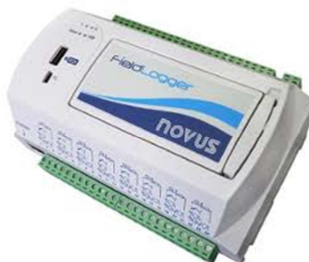
Figura 19 - Data Logger utilizado no projeto
