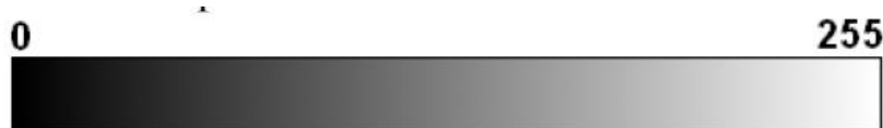
Figura 7 : Escala de cinza de uma imagem monocromática de 8 bits Fonte: (MELO; ROLOFF, 2008)
