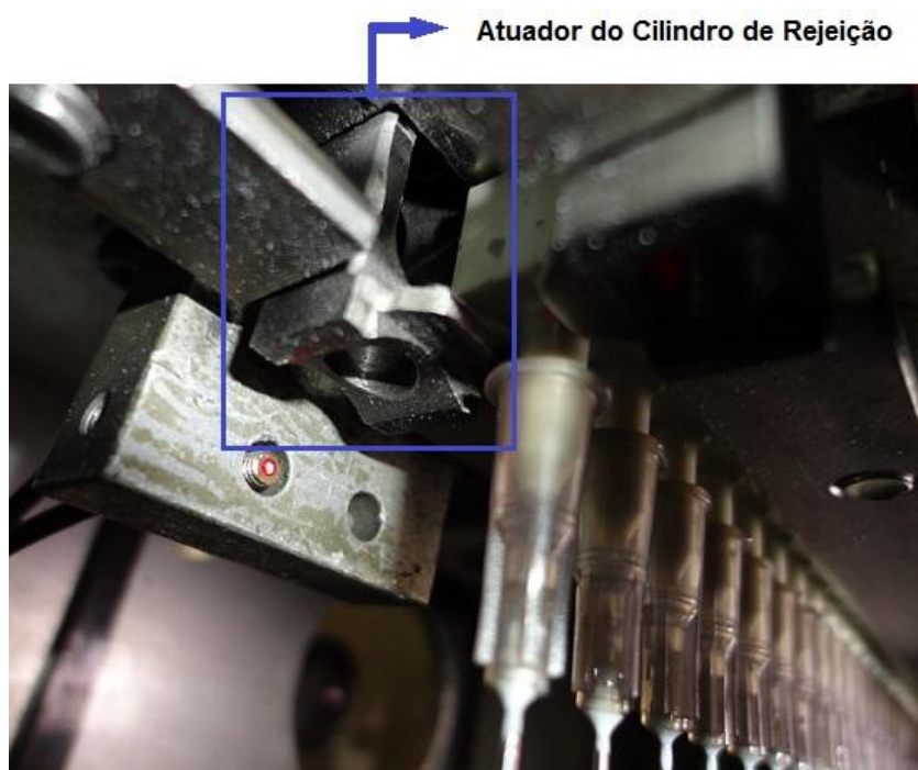
Figura 32: Estação de rejeição Fonte: Autoria própria
