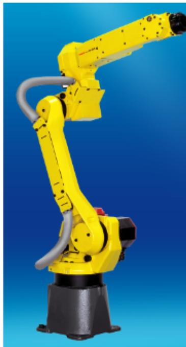
Figura 11 – Robô, modelo M10iA
