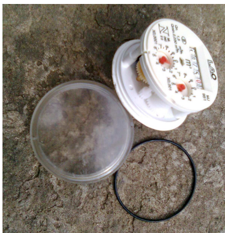
Figura 10: Sistema de relojoaria do hidrômetro
