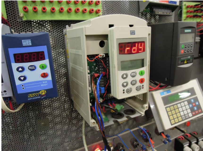
Figura 45 – Conexão dos fios de comunicação no inversor
