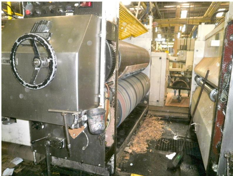
**Figura 44 – Imagem máquina impressora flexográfica**
