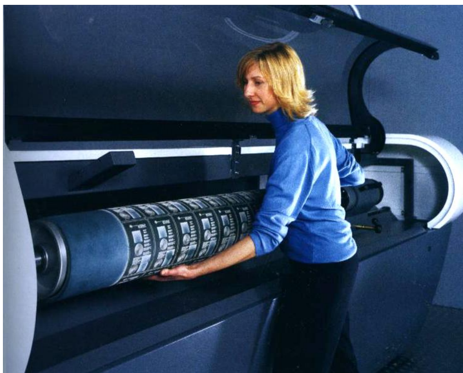
Figura 10 – Equipamento de gravação a laser modelo Morpheus da Stork
