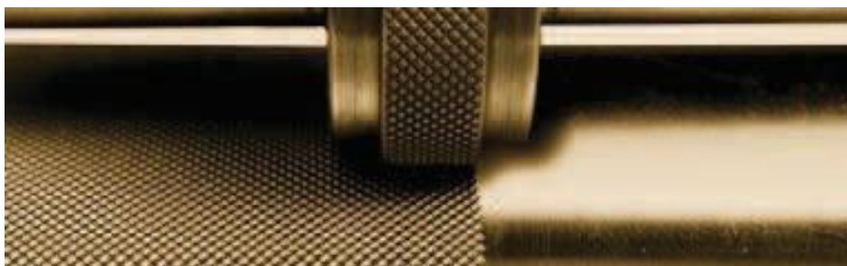
Figura 15 – Gravação Mecânica (Recartilagem)
