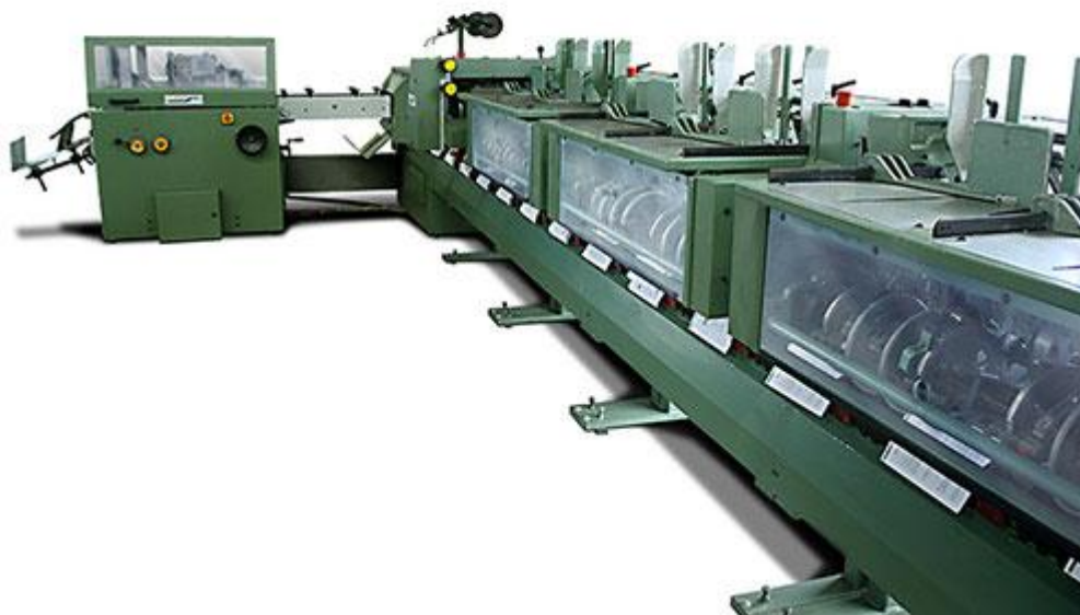
FIGURA 08 – Acabamento Grampeado Automatizado
