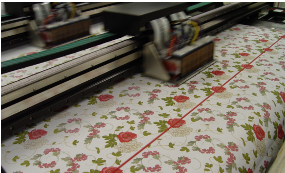
Figura 64 – Impressão direta a jato de tinta. Fonte: Dtprint (2012)
