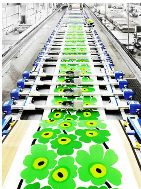
Figura 37 - Impressão do tecido para estampa corrida por serigrafia de quadros automáticos. Fonte: Marimekko (2008)
