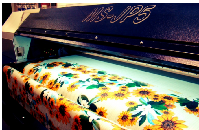
Figura 58 – Impressão por sublimação em larga escala. Fonte: La Estampa (2013)
