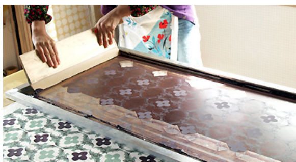
Figura 51 - Impressão do tecido para estamperia Fonte: MAKUMO (2010)
