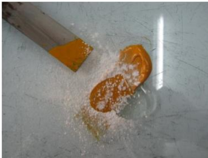
Figura 48 – Preparo de tinta com tinta off-set amarela, óleo de linhaça, talco e pó-antimaculador. Fonte: arquivo pessoal da autora
