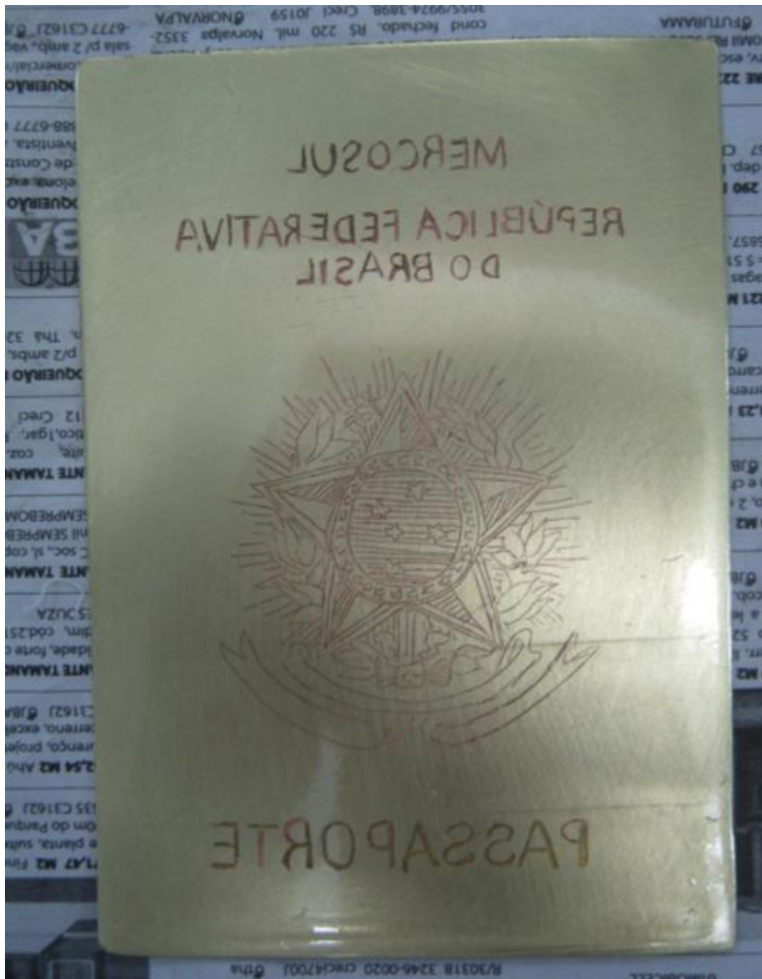
Figura 45: matriz de latão com gravação em água-forte Fonte: Arquivo pessoal da autora
