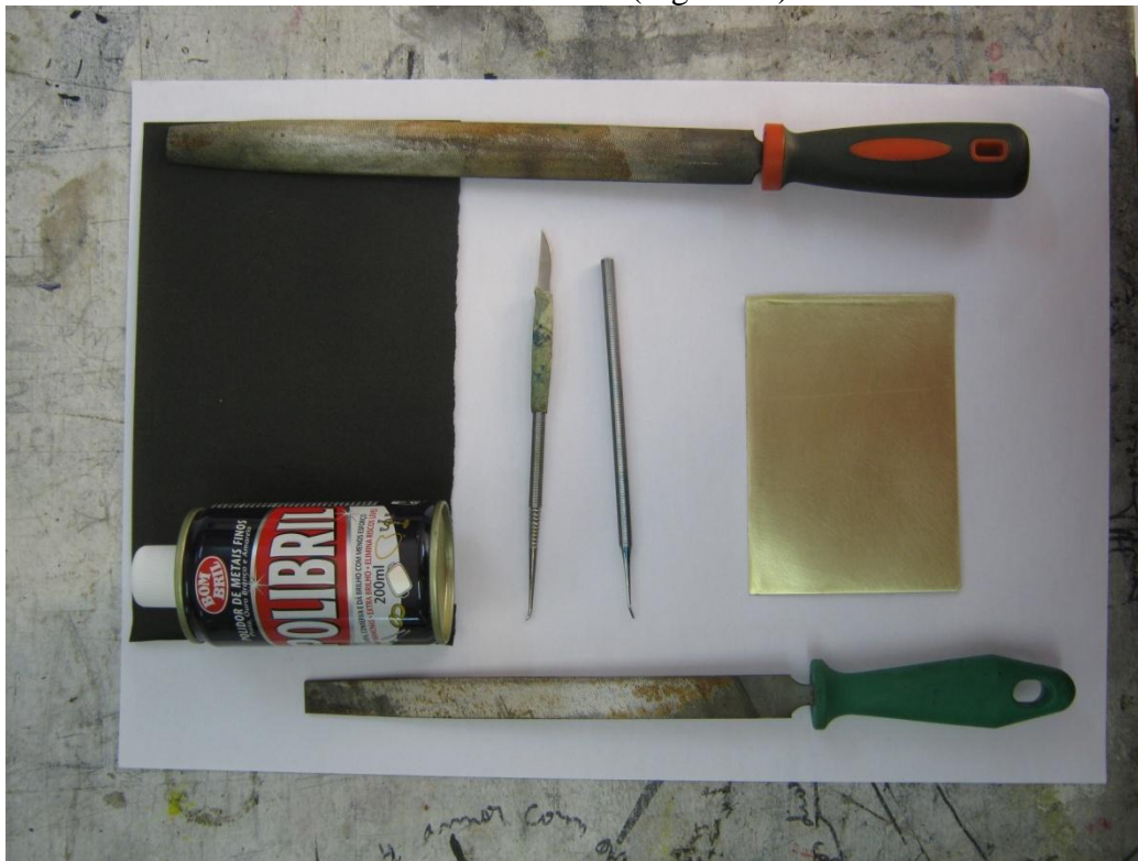
Figura 32: Lixa d'água, polidor de metais, limas, bisturi, espátula de inserção, chapa de latão. Fonte: Arquivo pessoal da autora.
