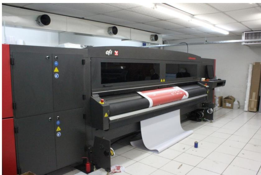
**Figura 24 - Impressora digital a qual suporta mídias de até 2,0m de largura.**
