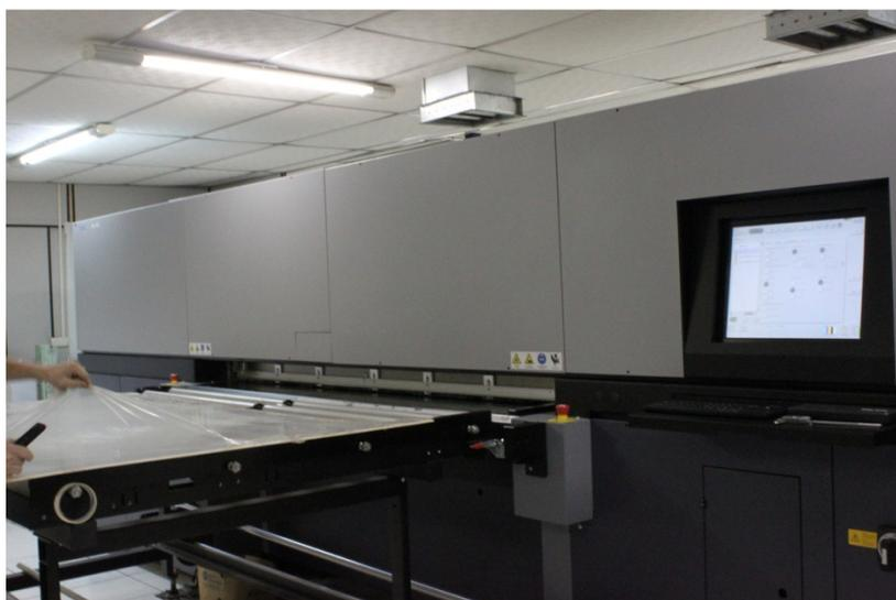
**Figura 23 - Impressora digital que suporta mídias tanto rígidas quanto maleáveis.**
