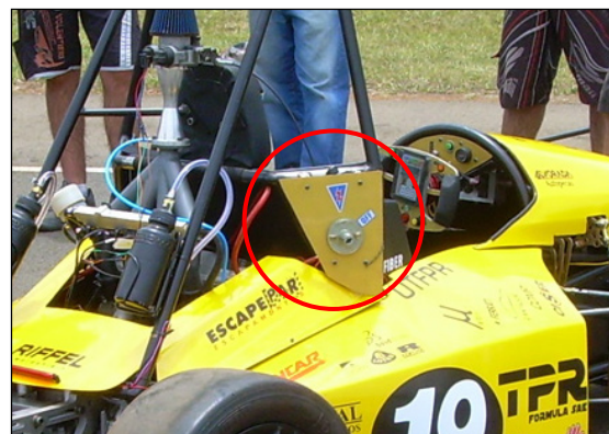
Figura 52 – Detalhe da chave geral Fonte – Subgrupo Design TPR (2010)
