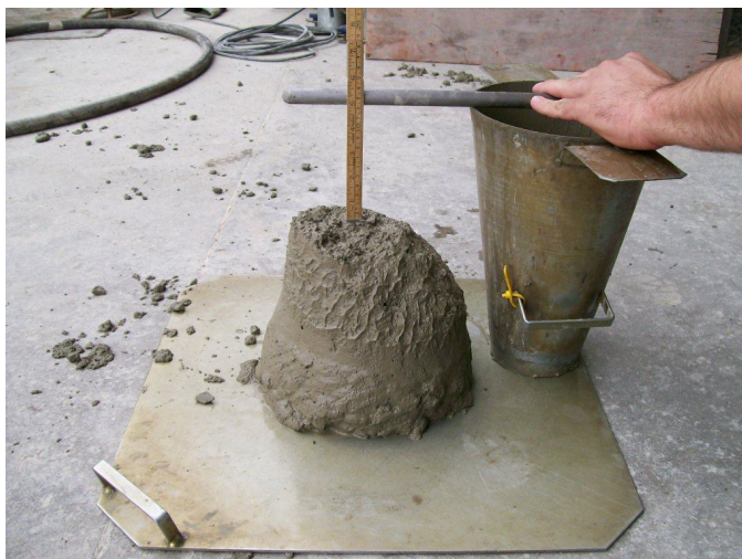
FIGURA 10 – Ensaio de abatimento do tronco de cone (ensaio slump test) Fonte: os autores
