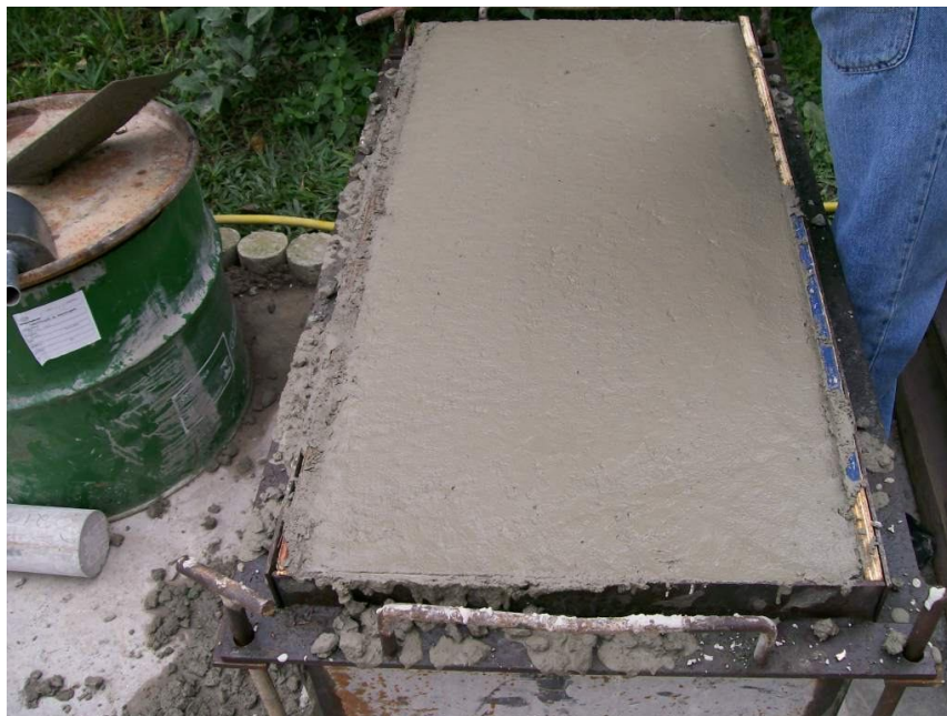
FIGURA 12 – Moldagem do bloco 1x0,5x0,5m em estrutura metálica. Fonte: os autores
