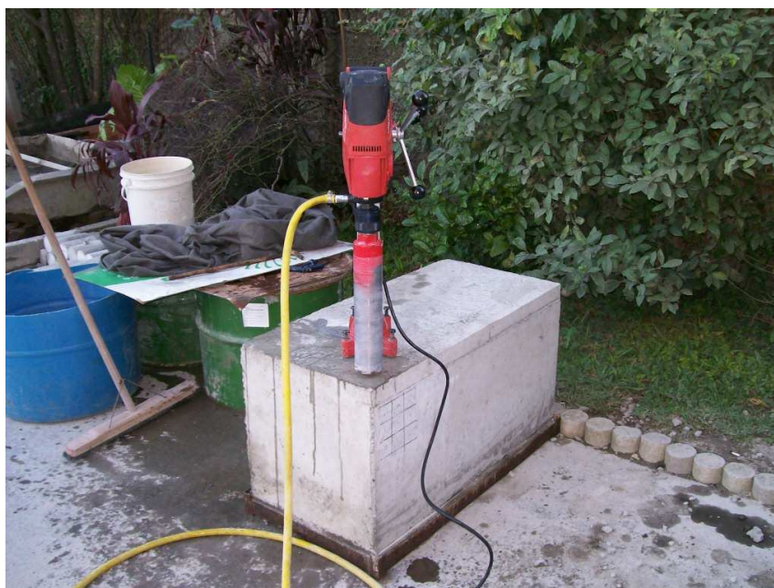
FIGURA 15 – Bloco e equipamento para extração de testemunhos. Fonte: os autores
