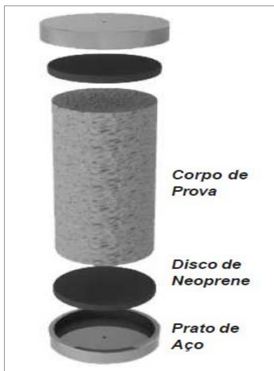
Figura 4 – Capeador elastomérico - Base metálica com anel de retenção e almofadas de neoprene
