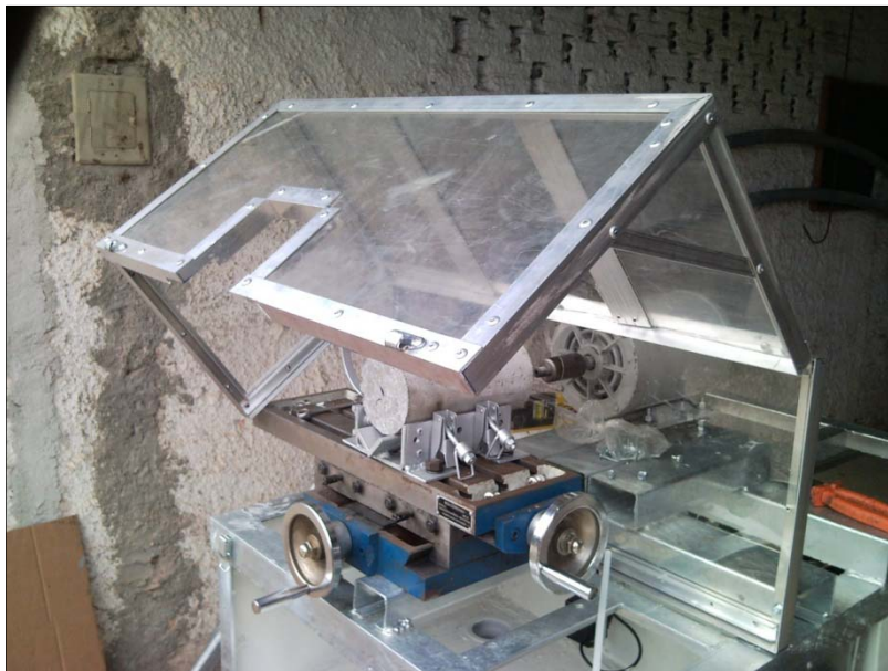
Figura 6 – Retífica com disco adiamantado fixo e movimentação do corpo-de-prova em mesa coordenada
