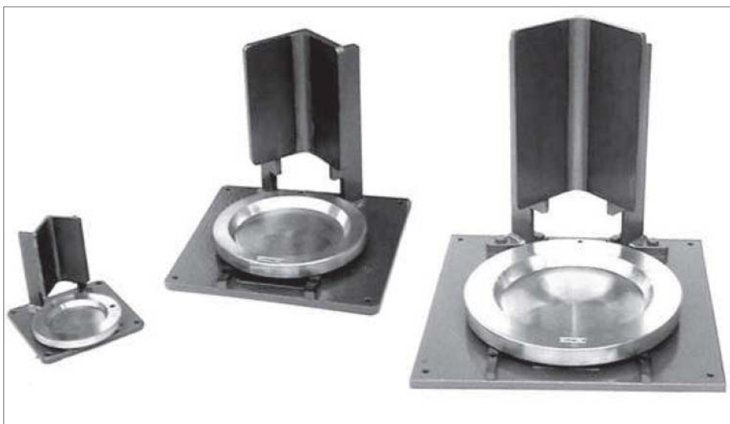
Figura 1 – Capeador de enxofre para corpos-de-prova de concreto
