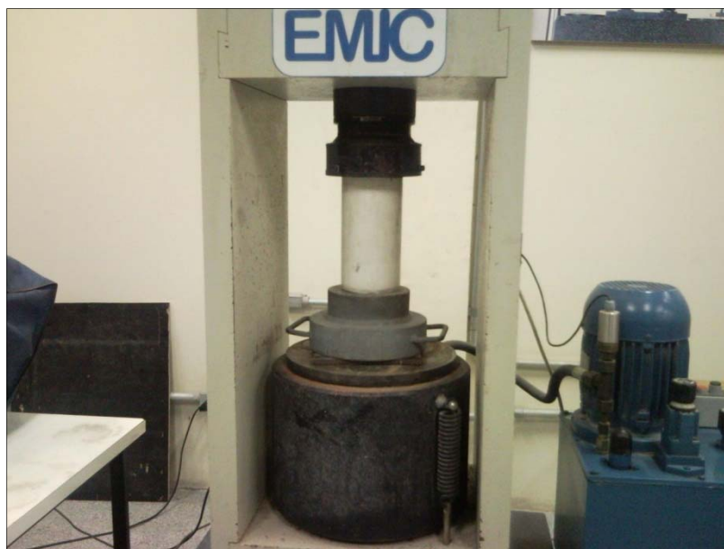
Figura 8 – Corpo-de-prova sendo submetido a um ensaio de compressão axial
