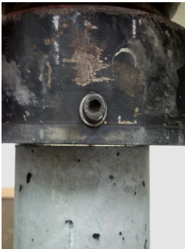
Figura 29 – Ajuste do êmbolo da prensa ao corpo-de-prova
