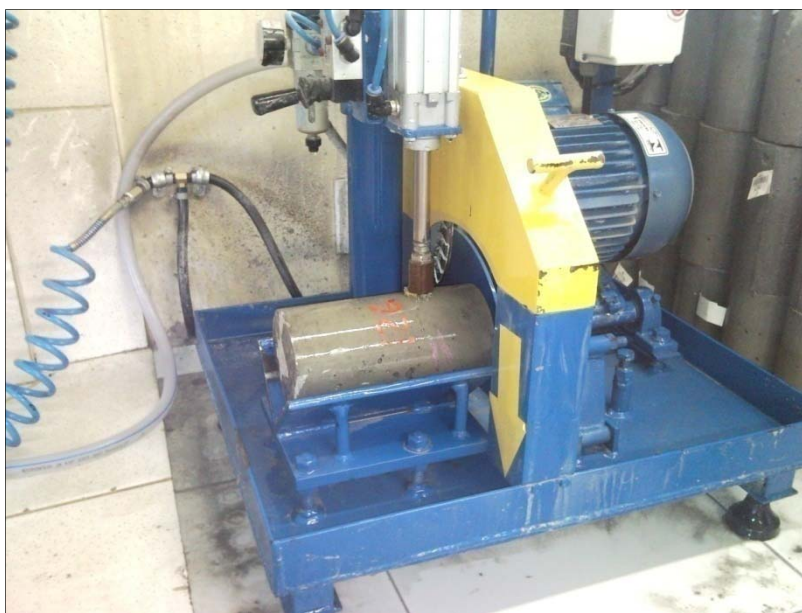
Figura 5 – Retífica com fixação do corpo-de-prova pneumática e com disco rotativo adiamantado móvel
