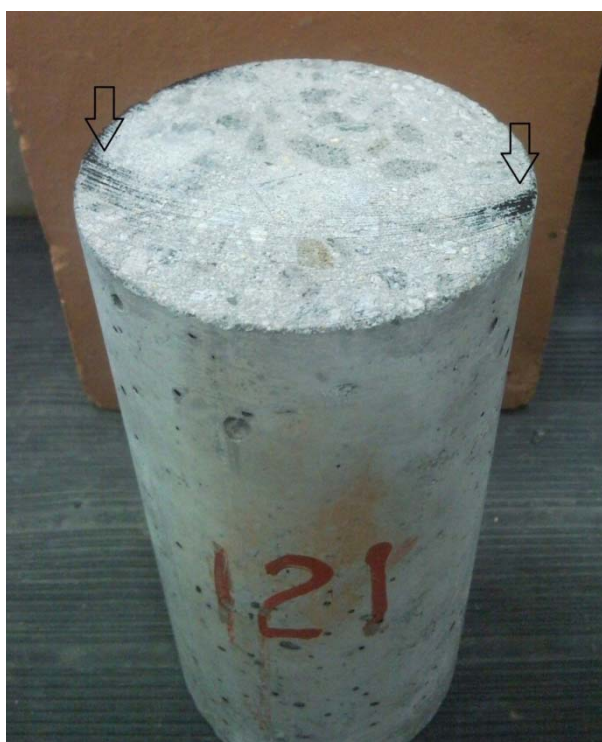
Figura 28 – Teste do carbono efetivo em corpo-de-prova retificado
