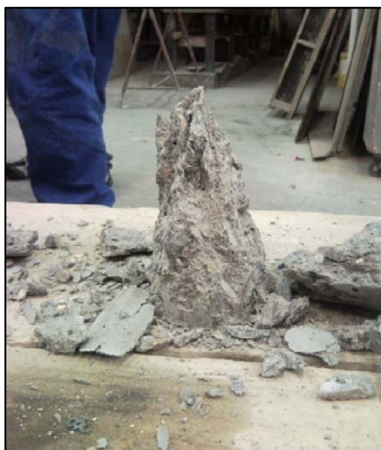
Figura 9 – Corpo-de-prova com ruptura cônica, consequência de adensamento e retífica satisfatórios.
