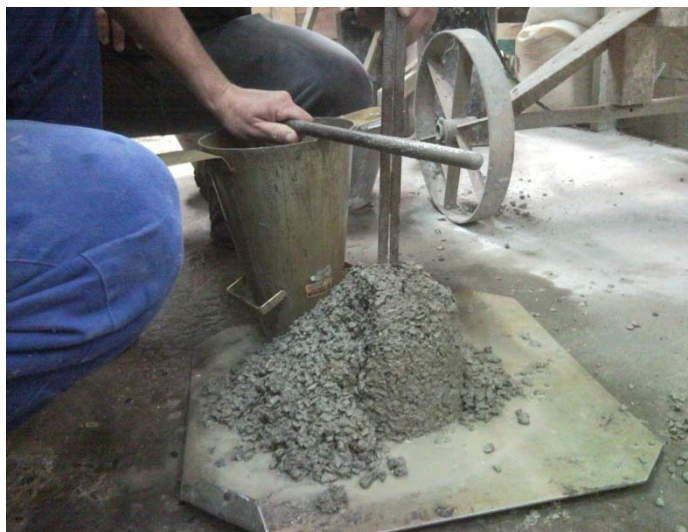
Figura 23 – Ensaio de consistência através do teste de abatimento do tronco de cone (slump test)
