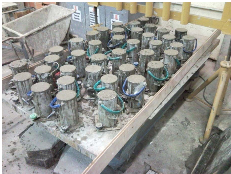
Figura 24 – Adensamento mecanizado dos corpos-de-prova
