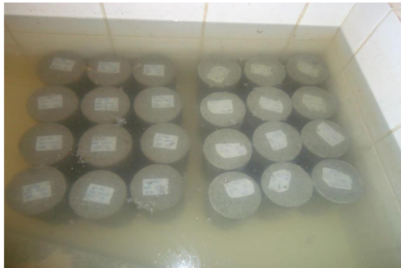
FIGURA 03 – Corpos de prova submerso em câmara úmida Fonte: Os Autores
