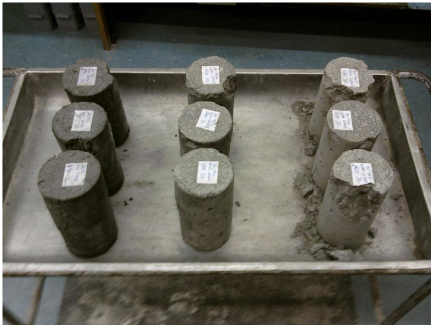
FIGURA 11 – Corpos de prova aos 28 dias após o rompimento (Cura Submersa/ Cura Química/ Cura Normal) Fonte: Os Autores
