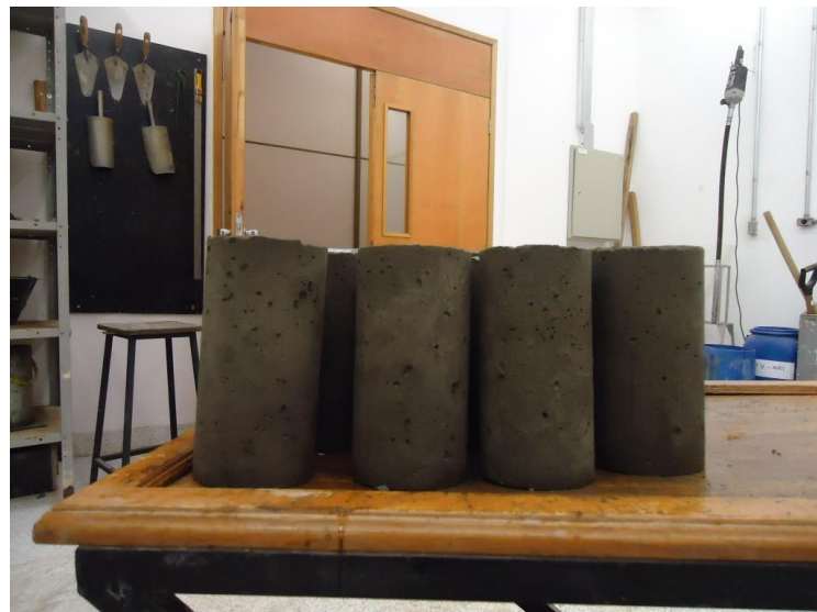
FIGURA 04 – Corpos de Prova após aplicação do aditivo de cura superficial Fonte: Os Autores
