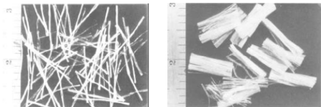
Figura 5 - Fibras de Polipropileno retorcidas e fibriladas (NAAMAN, 1991)
