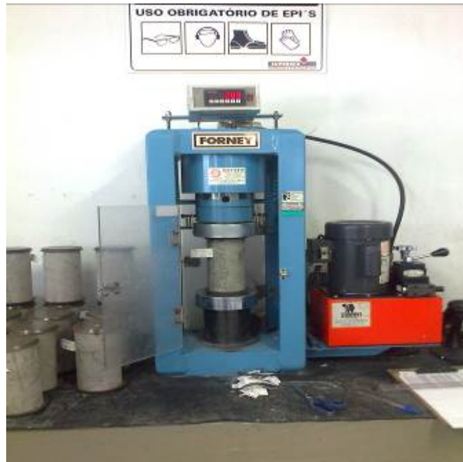
Figura 18 - Prensa hidráulica utilizada para rompimento de corpos de prova Fonte: os autores
