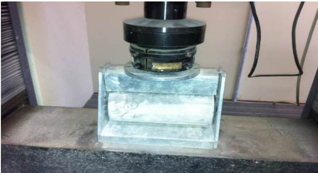
Figura 21 - Prensa hidráulica com adaptador para compressão diametral
