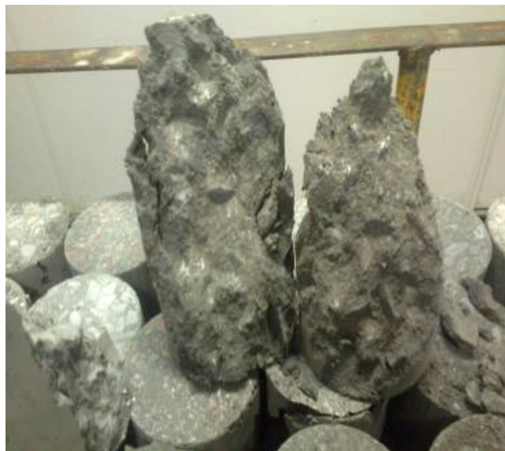
Figura 19 - Corpos de Prova rompidos Fonte: os autores
