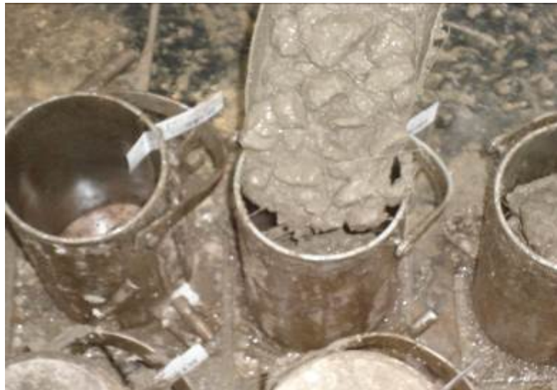
Figura 15 - Moldagem de corpos de prova cilíndricos;
