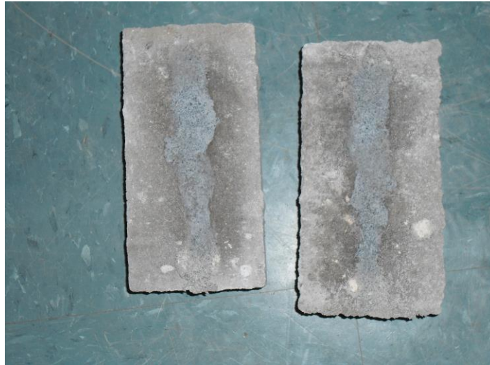
Figura 24 - Paver AQA EST02 sem aderência
