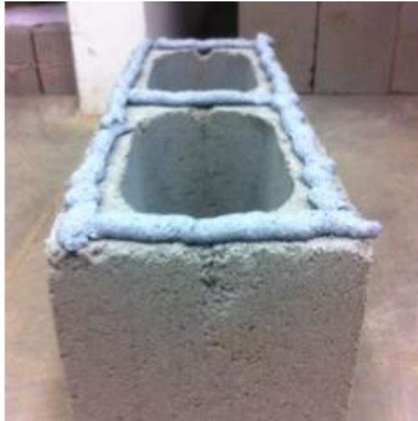
Figura 27 - Detahe da aplicação da AQB no bloco
