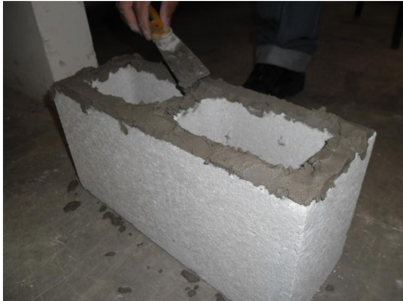
Figura 12 - Moldagem do prisma de ACI
