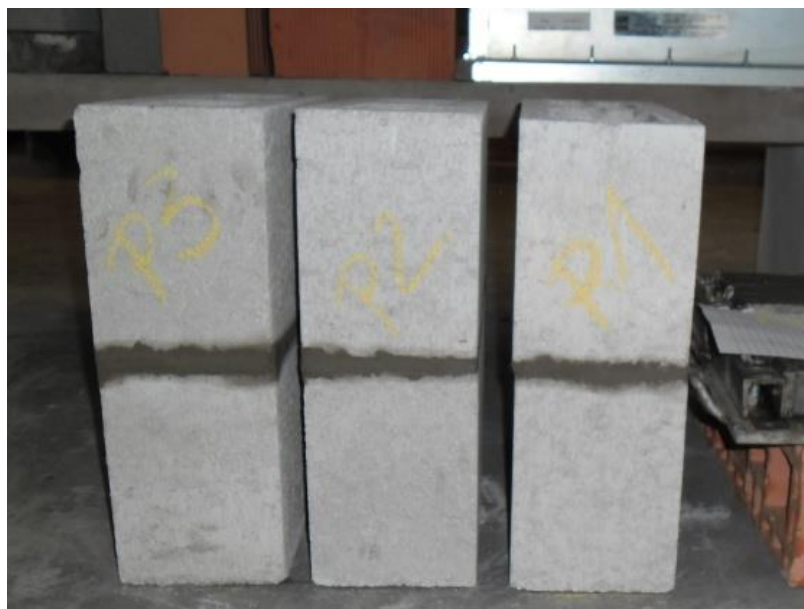
Figura 15 - Prismas de ACI finalizados
