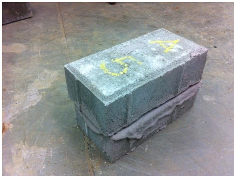
Figura 21 - Deslocamento do Paver superior do CP 05 (AQA-EST01)
