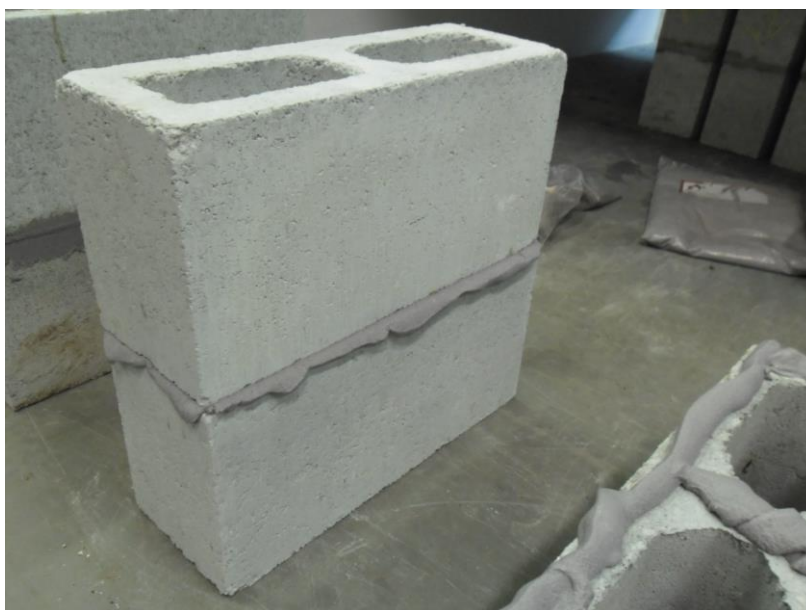
Figura 17 - Moldagem do prisma com AQA
