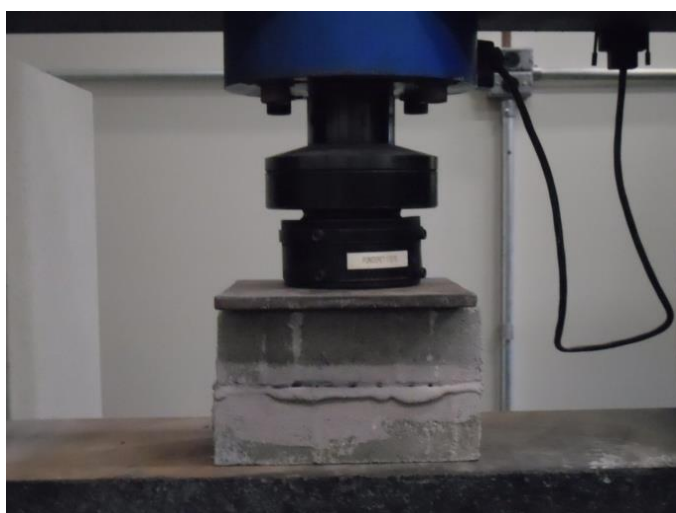
Figura 37 - Rompimento do Paver de AQA
