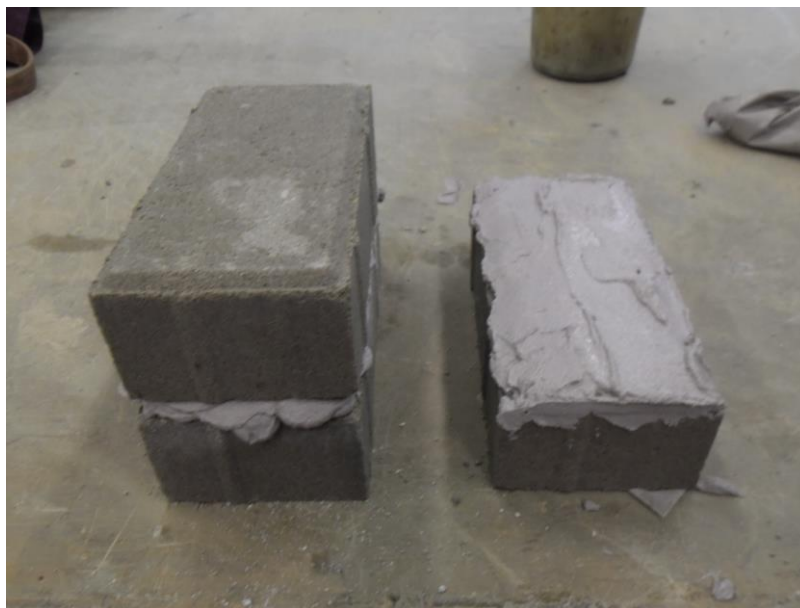
Figura 19 - Moldagem do Paver com AQA-EST01
