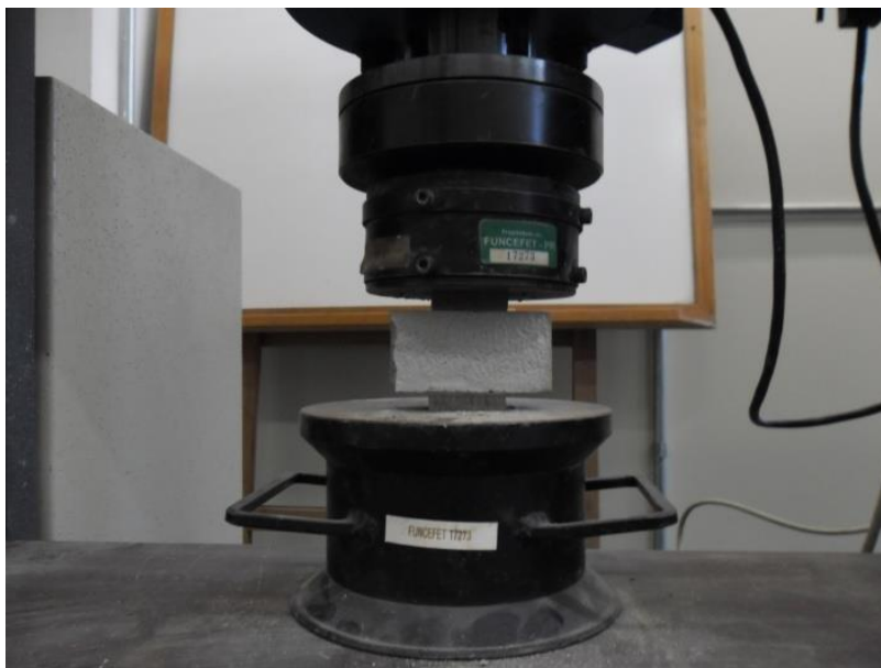
Figura 35 - Ensaio de compressão do corpo de prova de ACI
