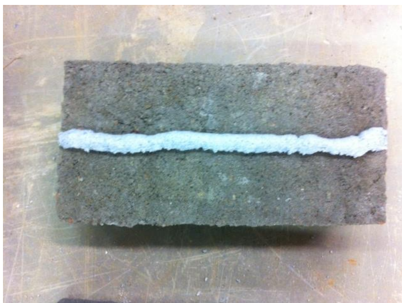
Figura 30 - Aplicação da AQB no Paver
