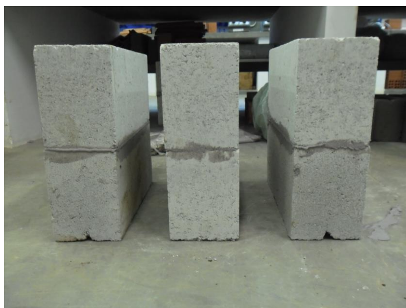
Figura 18 - Prismas de AQA finalizados
