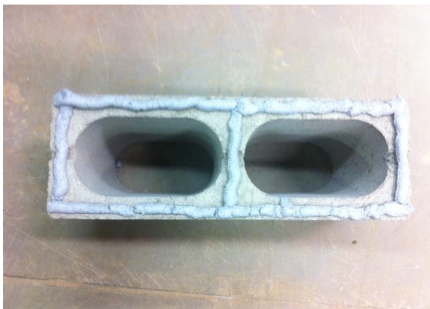
Figura 26 - Aplicação da AQB no bloco
