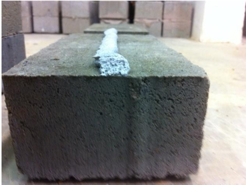
Figura 31 - Detalhe da espessura da AQB no Paver
