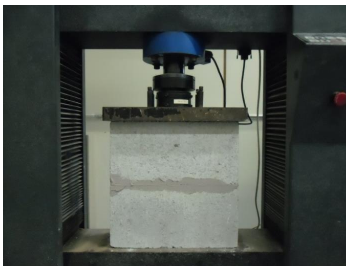
Figura 36 - Rompimento do prisma de AQA
