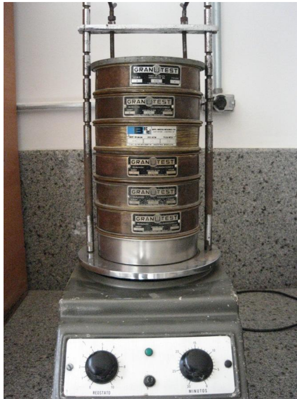
Figura 3.3 – Peneirador mecânico com peneiras da serie normal
