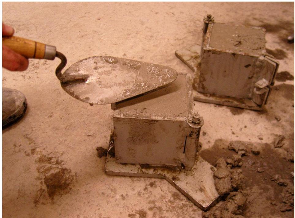
Figura 12– Acabamento da moldagem do corpo de prova cúbico
