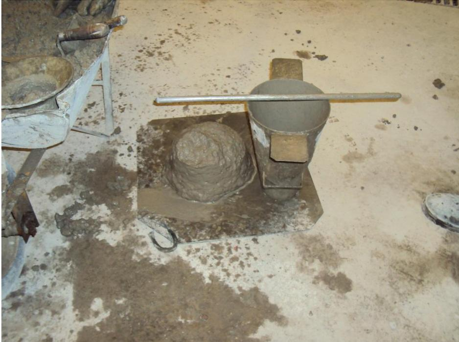
Figura 07 – Consistência obtida no ensaio.
