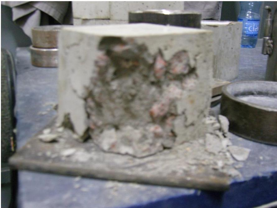
Figura 19 – Forma de ruptura do corpo de prova cúbico.
