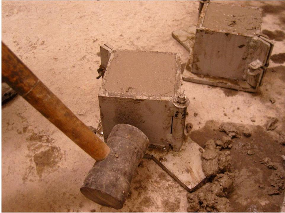
Figura 11– Finalização da moldagem do corpo de prova cúbico
