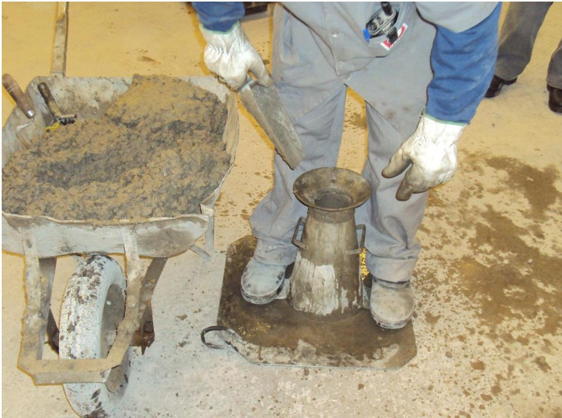
Figura 04 – Preenchimento do molde tronco-cônico.
