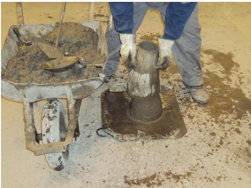
Figura 06 – Retirada do cone.
