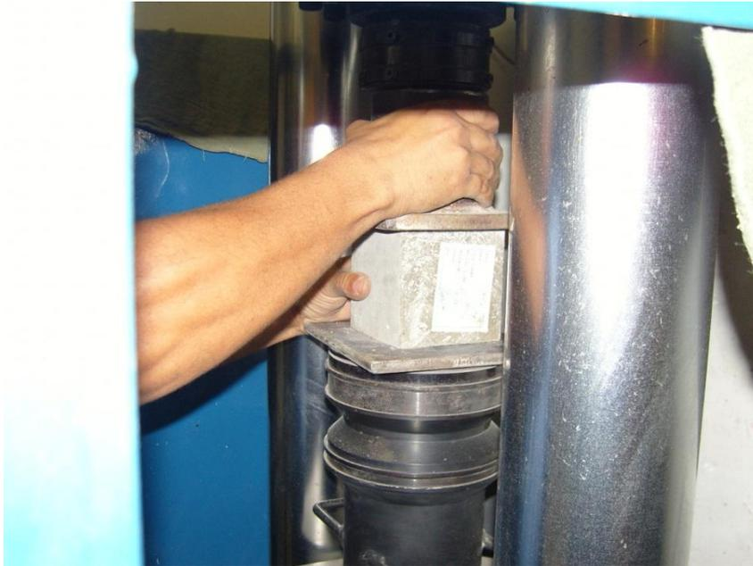
Figura 18 – Rompimento do corpo de prova cúbico.
