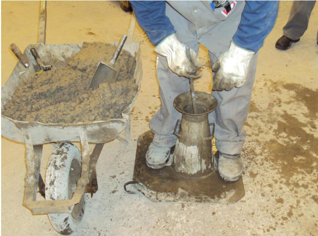
Figura 05 – Adensamento do concreto no molde
