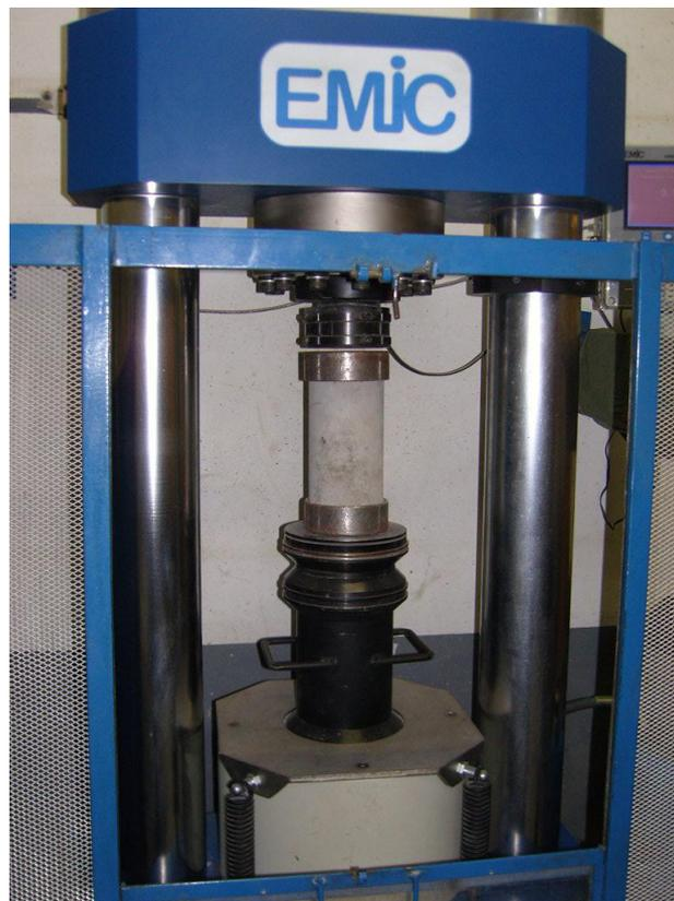
Figura 17 – Rompimento do corpo de prova cilíndrico
