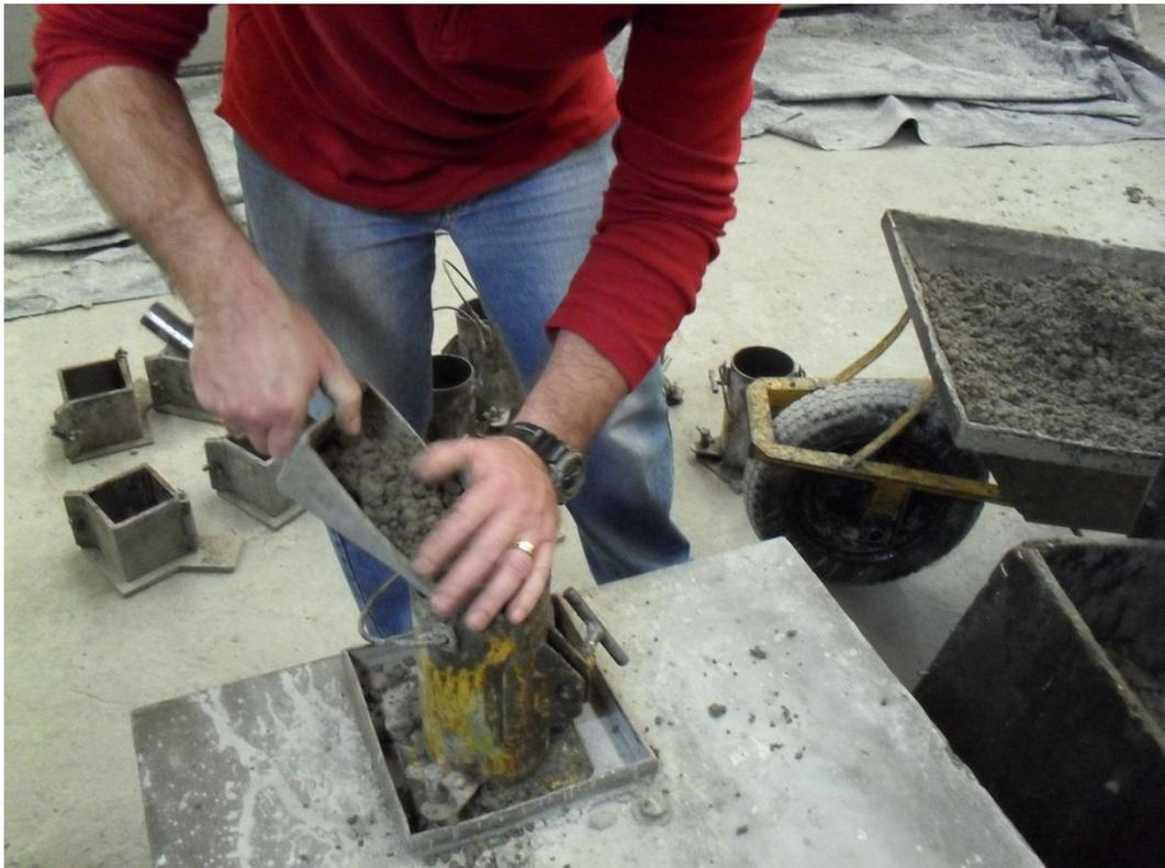
Figura 09 – Preenchimento do corpo de prova
