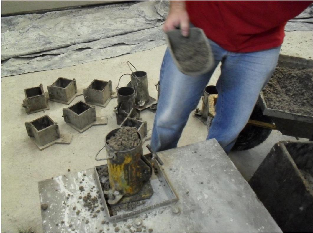
Figura 10 – Adensamento em mesa vibratória
