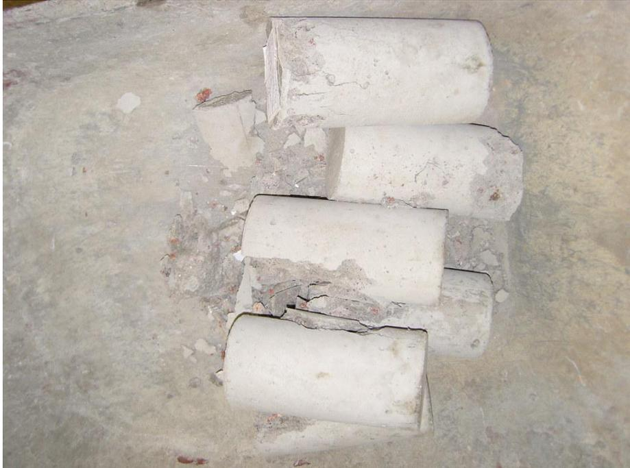
Figura 20 – Forma de ruptura do corpo de prova cilíndrico.
