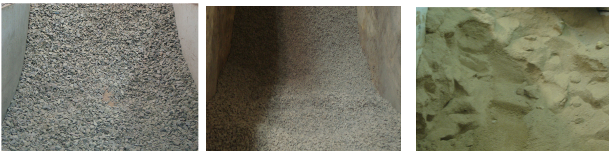
Figuras 1, 2 e 3 – Agregados do concreto ABCP Brita 1, Brita 0 e Areia
