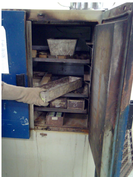
Figura 8 – Estufa para secagem dos agregados
