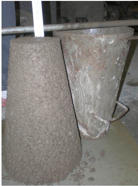
Figura 8 – Ensaio Slump Test do concreto ensacado Fonte: PRÓPRIA, 2011.
