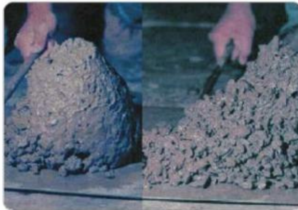
Figuras 2 e 3 – Concreto coeso e concreto não coeso Fonte: HELENE e TERZIAN, 1993.
