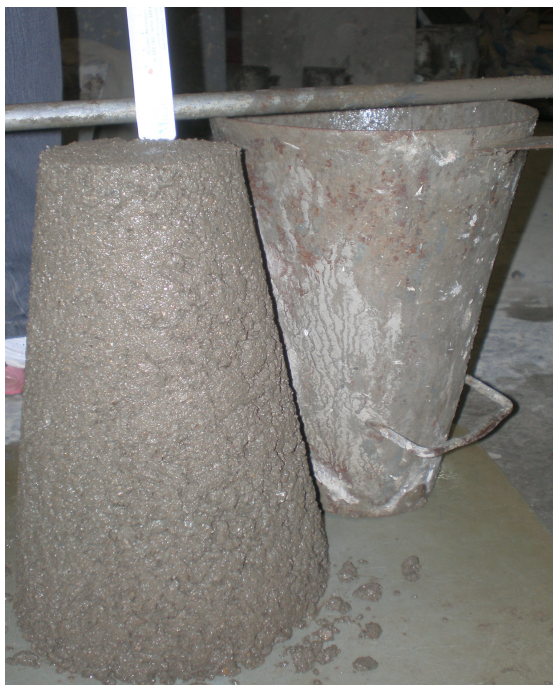
Figura 1- Ensaio de consistência pelo abatimento do tronco de cone Fonte: PRÓPRIA, 2011.
