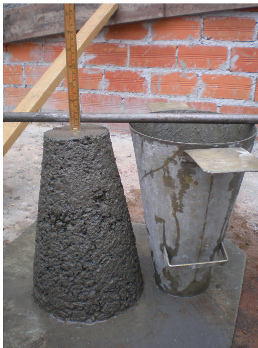
Figura 13 – Ensaio “ Slump Test ” do concreto ensacado Fonte: PRÓPRIA, 2011.
