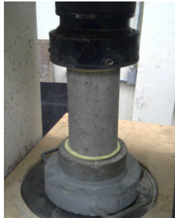
Figura 9 – Ensaio Resistência a compressão axial Fonte: PRÓPRIA, 2011.
