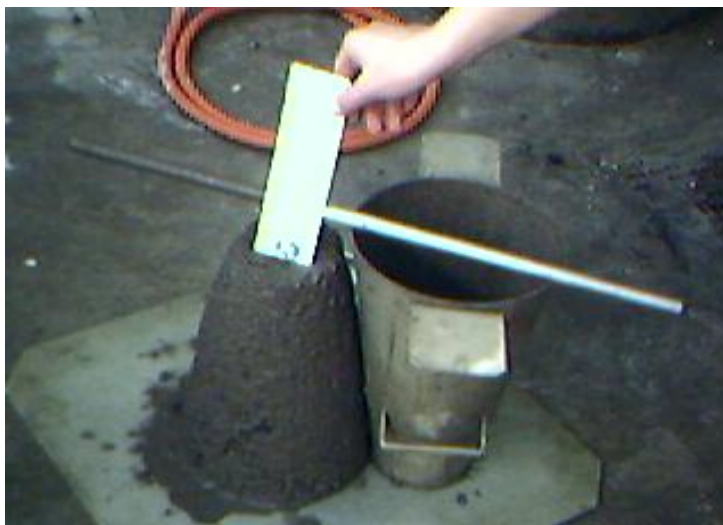
Figura 7 – Ensaio Slump Test do concreto dosado pelo método ABCP Fonte: PRÓPRIA, 2011.
