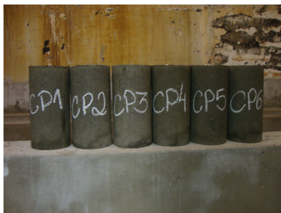
Figuras 6 e 7 – Ensaio de resistência – Corpos de prova
