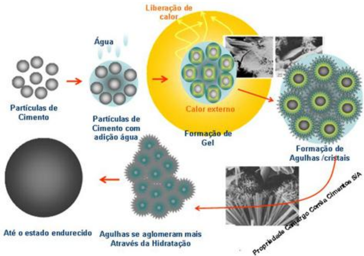
Figura 2- Processo de aglomeração do cimento
