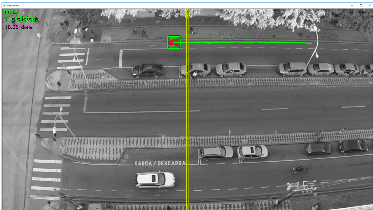
Figura 24: Região de contagem do protótipo desenvolvido. A linha em amarelo identifica o ponto em que um objeto é contado caso esteja classificado como ciclista.
