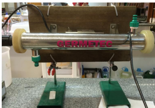
Figura 4: Esquema e foto do reator com lâmpada de mercúrio de baixa pressão.
