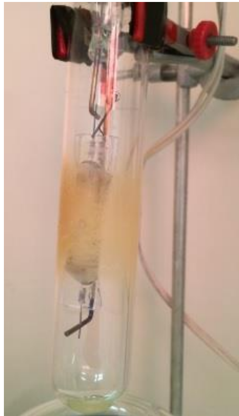
Figura 24: Precipitado junto ao bulbo da lâmpada formado após o processo UV/H 2 O 2 da amostra com pré-tratamento de hidrólise ácida.
