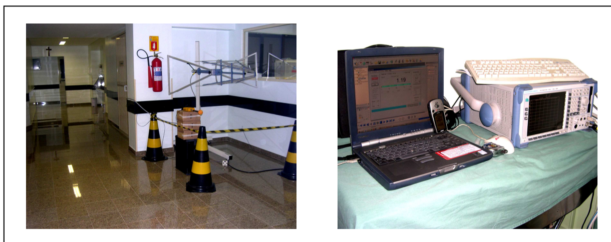
Figura 7. Local da instalação das antenas no centro cirúrgico apresentando a antena seletiva, a sonda isotrópica conectada ao medidor de campo isotrópico, o receptor/analizador de sinais de radiofrequência, notebook e um GPS.
