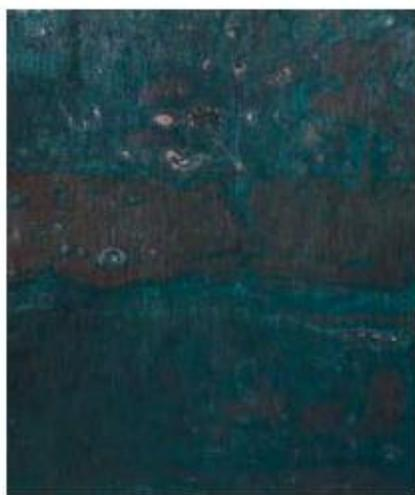
**Grau C** – superfície de aço na qual a carepa de laminação já deu lugar a oxidação, podendo o restante ser removido por raspagem.
