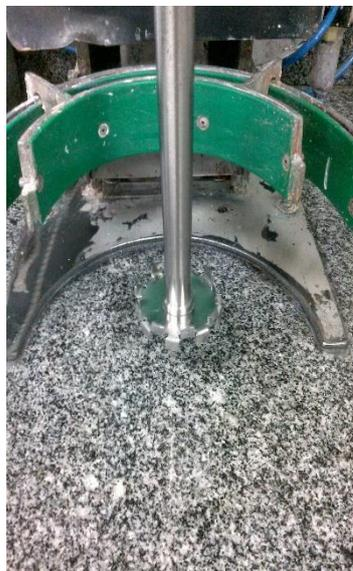
Figura 13: Disco dispersor utilizado para produzir as tintas em laboratório
