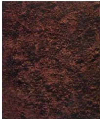
Figura 10: Graus de corrosão da superfície do aço conforme norma ISO 8501-1
