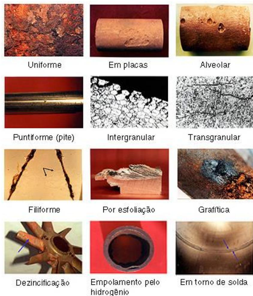
Figura 9: Diferentes tipos de corrosão (Gentil, 1996)
