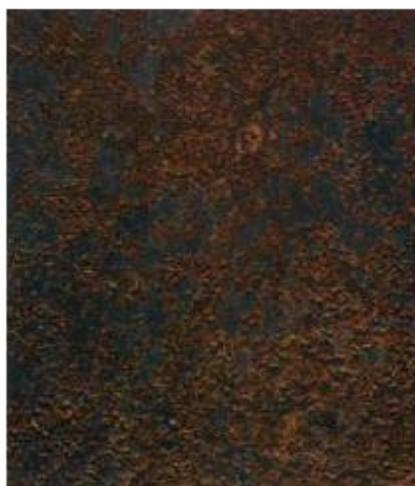
**Grau D** – superfície de aço onde já se apresenta corrosão acentuada com presença de *pits* e alvéolos.
