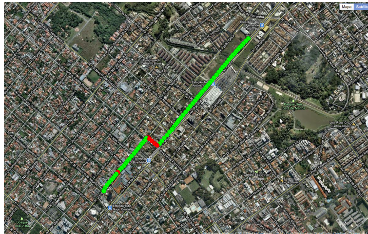
Figura 15: Trajeto da primeira aproximação na avenida Paraná. Círculos vermelhos assinalam potência recebida abaixo do limiar.
